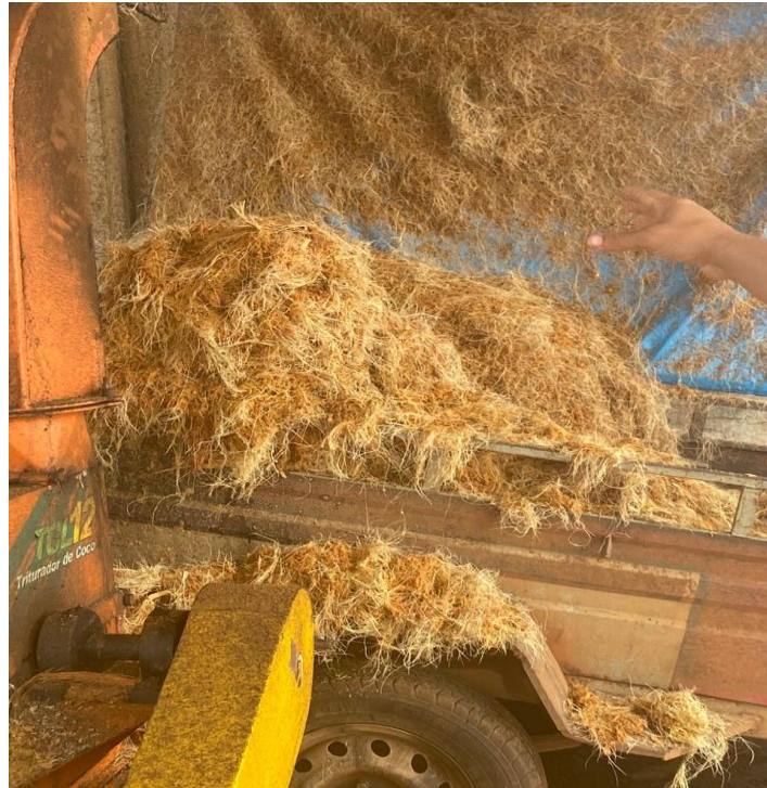
Figura 19 – Trituração do resíduo do coco verde
