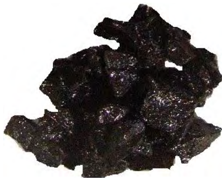
Figura 4.4 - Adesividade do agregado calcário ao ligante betuminoso
