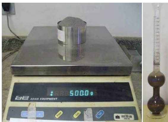
Figura 3.4 - Determinação do peso específica do pó-de-pedra; Frasco de Chapmam
