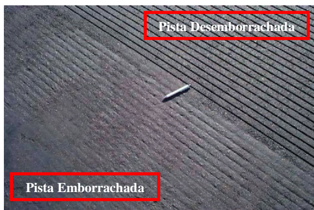
Figura 2.12 - Revestimento com grooving bastante contaminado; Detalhe do revestimento antes e após o desemborrachamento (Rodrigues Filho, 2006)
