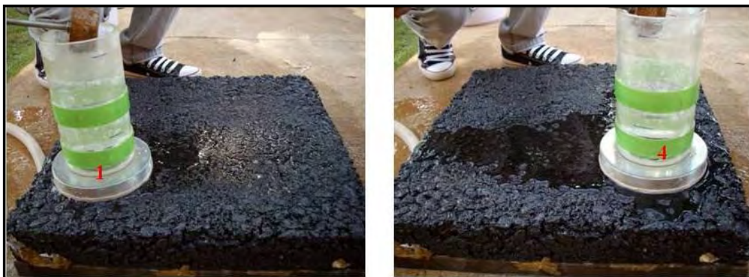
Figura 3.21 - Execução do ensaio de drenabilidade; LER-Ceftru-UnB
