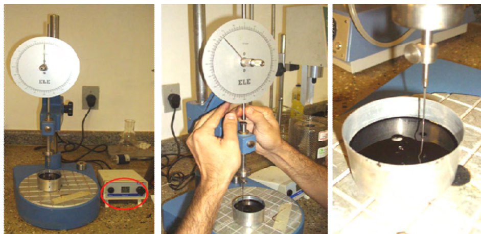
Figura 3.9 - Ensaio de penetração; Equipamento LER-Ceftru-UnB
