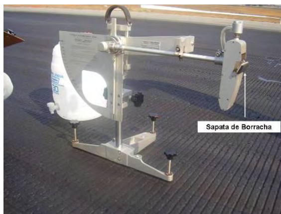
Figura 2.16 - Pêndulo britânico utilizado; LER-Ceftru-UnB
