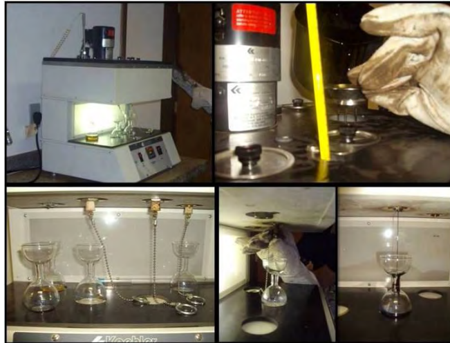
Figura 3.12 - Ensaio de viscosidade; Viscosímetro Saybolt-Furol – LER-Ceftru-UnB
