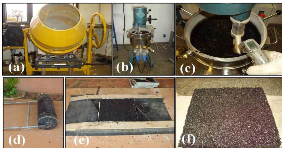
Figura 3.18 - Etapas da moldagem das placas asfáltica
