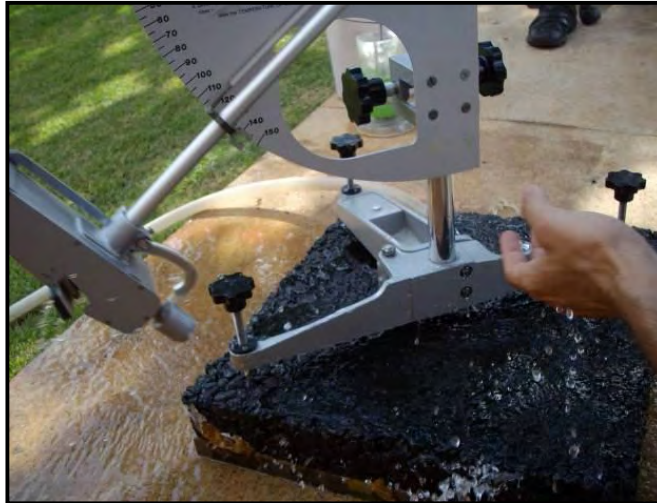
Figura 3.22 - Execução do ensaio de pêndulo na placa
