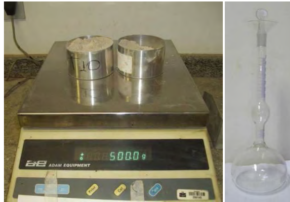
Figura 3.5 - Determinação do peso específica do filler; Frasco Le Chatelier
