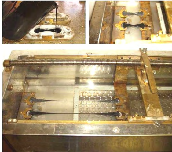
Figura 3.11 - Moldagem dos corpos-de-prova e execução do ensaio de ductilidade.
