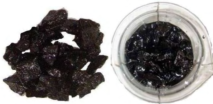
Figura 3.6 - Adesividade do agregado graúdo; Aspecto da amostra antes e após a imersão
