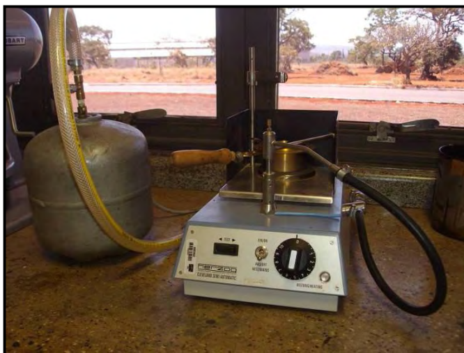
Figura 3.10 - Equipamento para determinação do ponto de fulgor; Vaso aberto de Cleveland; LER-Ceftru-UnB
