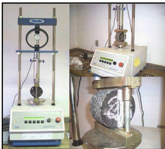
Figura 3.24 - Prensa mecânica utilizada para realização dos ensaios de resistência à tração; LER-Ceftru-UnB.
