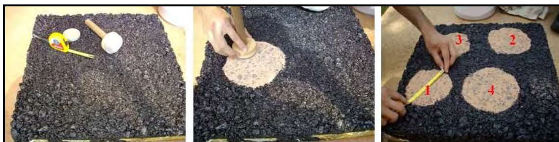
Figura 3.20 - Aparelhagem e procedimento de ensaio de mancha de areia
