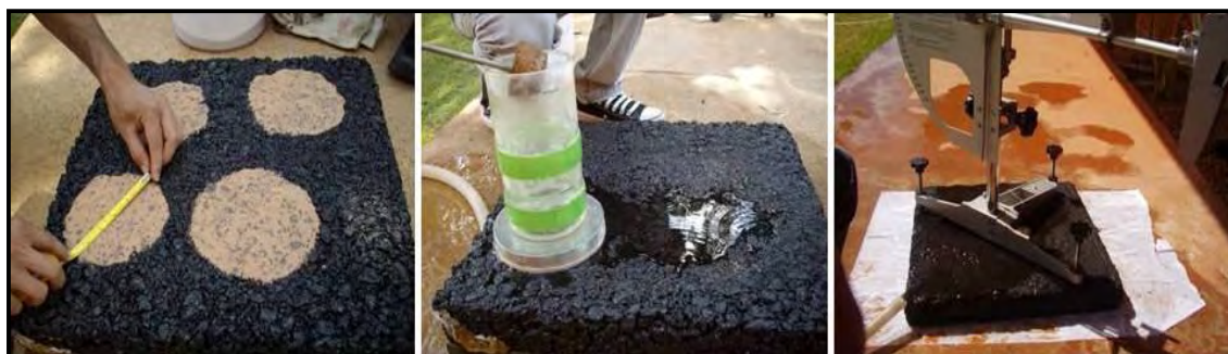
Figura 3.19 - Ensaio funcionais realizados em laboratório
