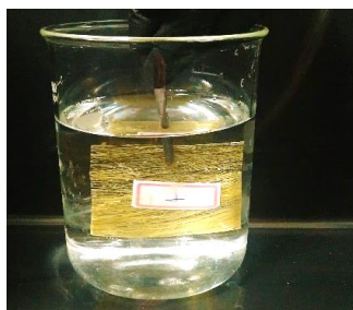
Figura 15. Pré-impregnado SisalNaOH15%/epóxi imerso em água destilada.
