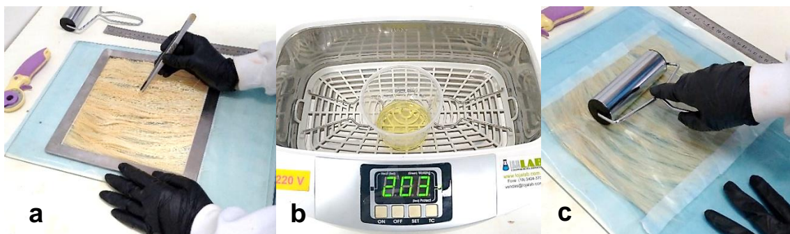
Figura 9. Processo de fabricação de pré-impregnado Sisal NaOH 15%(m/m)/ epóxi. (a) Distribuição e direcionamento das fibras. (b) Processo de degasagem do conjunto resina/endurecedor. (c) Impregnação manual com rolo cilíndrico.
