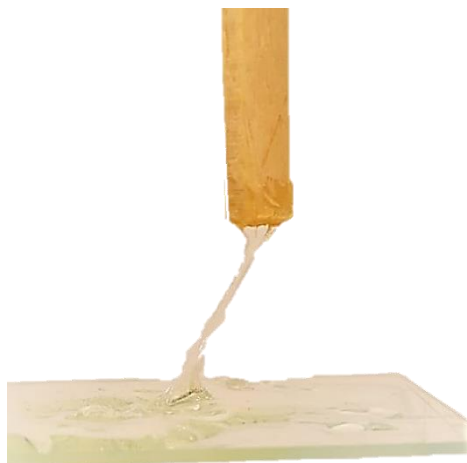
Figura 26. Comportamento elástico da resina epóxi durante o processo de gelificação.
