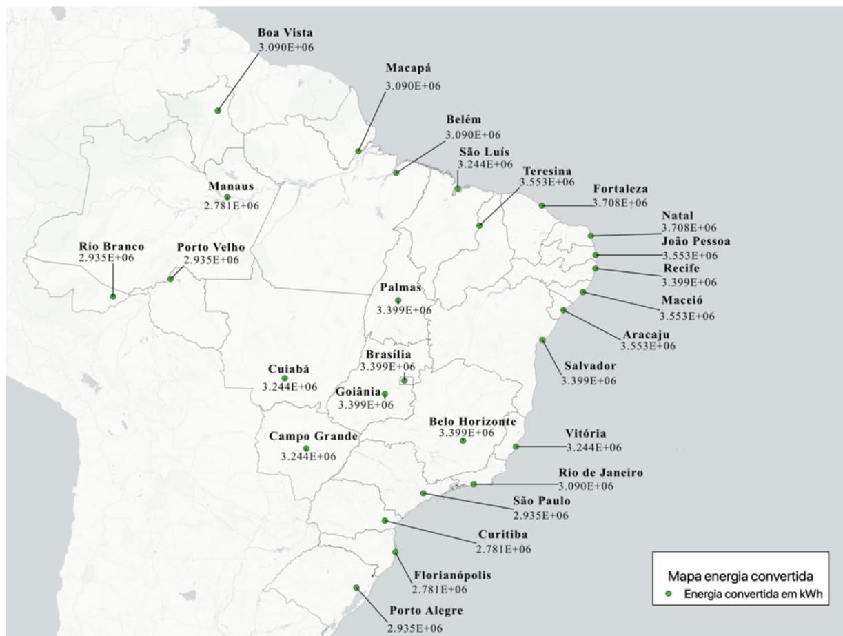
Figura 5.5 - Energia convertida pela planta solar em cada cidade selecionada ao longo de 25 anos.
