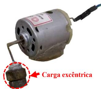
Figura 3-5: Motor com carga excêntrica para aplicação vibração forçada.
