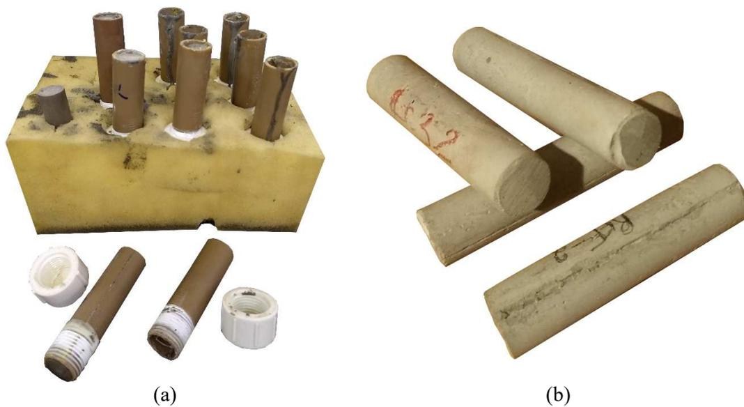
Figura 3-8: Corpos de prova para ensaio no sistema Sonelastic: (a) moldes; (b) corpos de prova.
