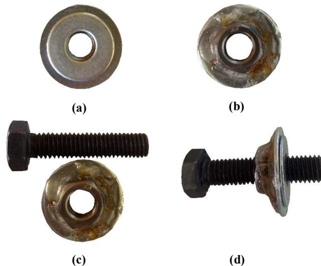
Figura 3-4: Tampa para expulsão de ar: (a) fundo, que fica no interior do tubo; (b) topo, no qual é colada uma rosca; (c) tampa vista de cima e parafuso; (d) rosqueamento do parafuso na tampa.
