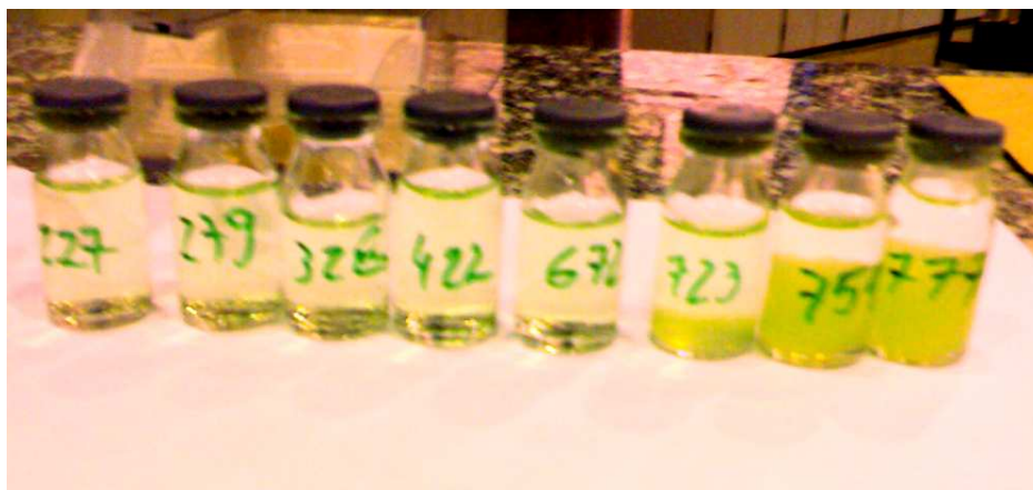
Figura 3.12: Fotografia do níquel em solução com diferentes pH em temperatura ambiente. Da esquerda para a direita os pH são respectivamente 2,27; 2,79; 3,28; 4,22; 6,72; 7,23; 7,51 e 7,77.
