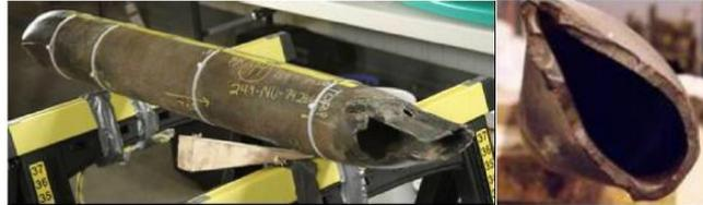
Figura 1.3 – Detalhes de tubo *Riser* com corte irregular e sem selagem.
