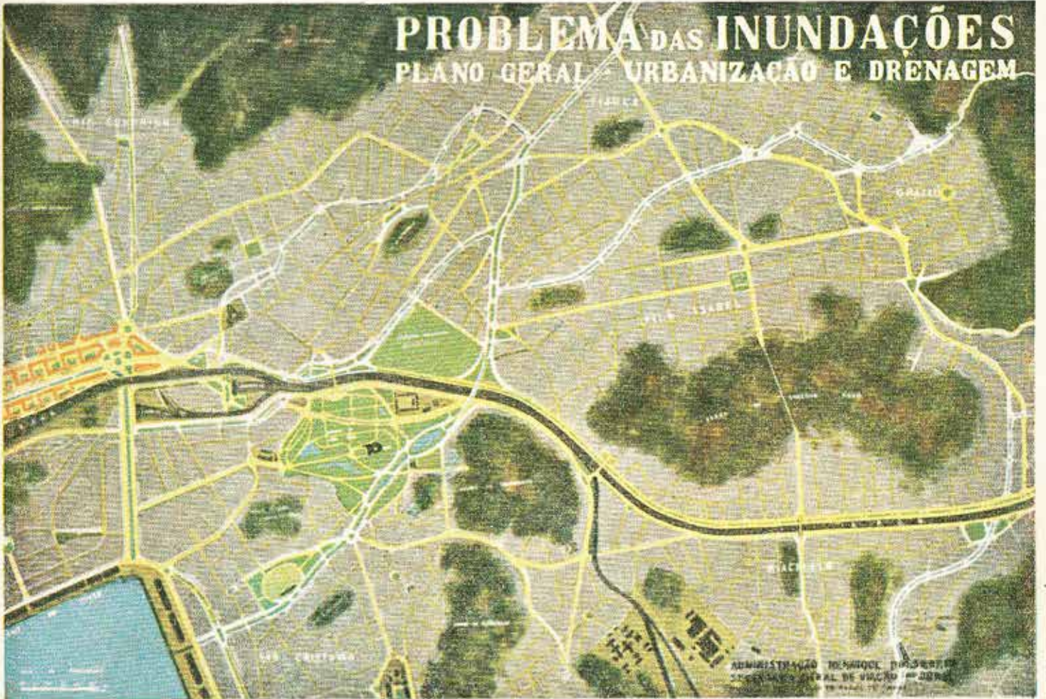
Planta demonstrando o traçado do "Canal Interceptor".
