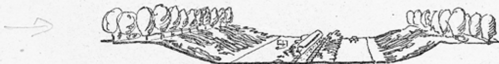
Fig. 94 — Secção transversal da mesma. No centro há duas vias de trem metropolitano, com estações nas pontes, dispondo de escadas de descida e subida.
