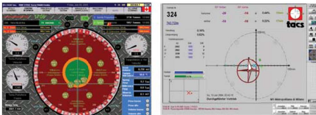
Figura 3.13 – Exemplo de um painel de controle (esquerda) e de uma tela de orientação (direita) de uma tuneladora EPB (Guglielmetti et al. , 2007).
