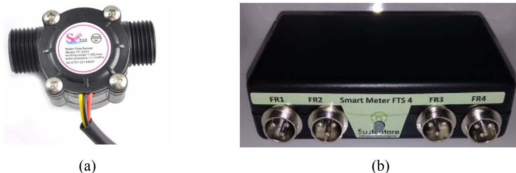
Figura 5 - Equipamento de medição composto por medidor de fluxo (a), e módulo data-logger (b).
