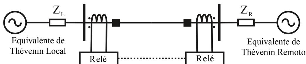
Figura 5.1. Sistema elétrico de potência analisado.
