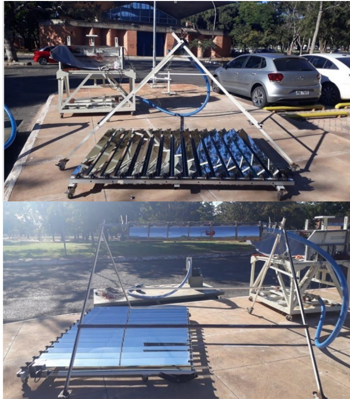
Figura 3.12: Concentrador refletor linear Fresnel pertencente ao LEA.
