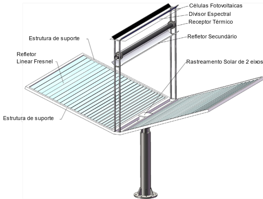
Figura 2.21: Sistema CPVT-LFR com rastreamento solar de dois eixos (Traduzido).
