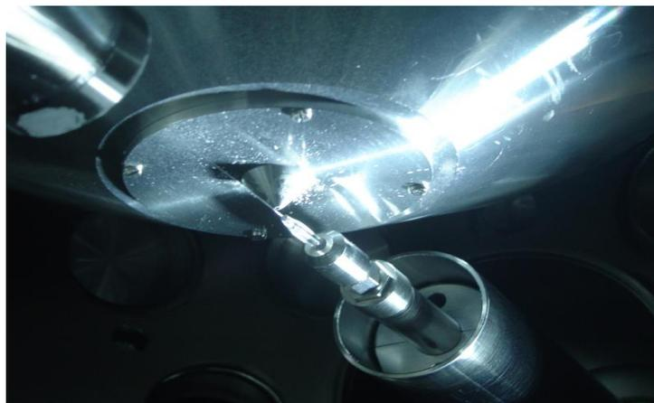
**Figura 11:** Foto do microjato líquido que já está em funcionamento com um espectrômetro de elétrons e está montado no LNLS, [25].
