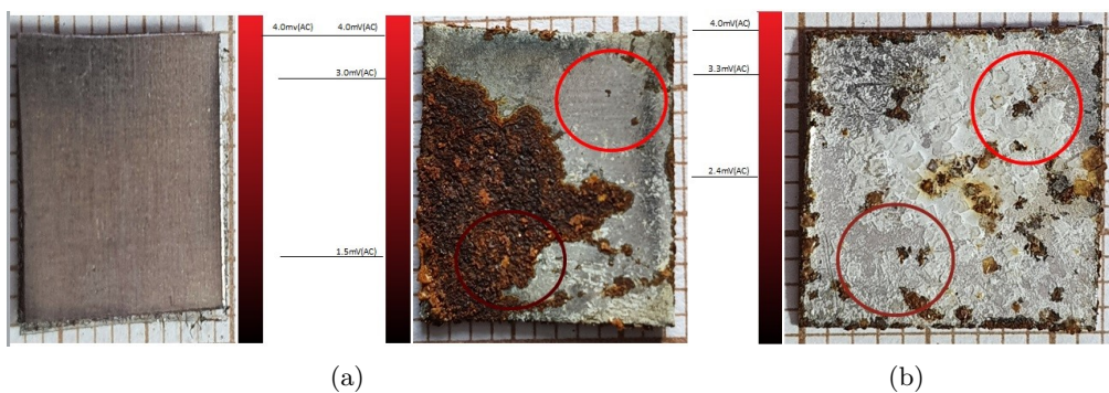
Figura 5.8: Gráfico demonstrativo das amostras básicas Aço mais OxAçA-g(a), comparação com amostra após processo de imersão OxAçB-b(b) Hipocloridrio + H 2 O + NaCl. Fonte: Elaborado pelo autor.
