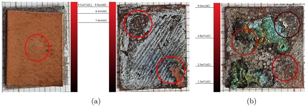
Figura 5.6: Gráfico demonstrativo das amostra básica CU mais OxCuA2-b(a) , comparação com segunda OxCuB2-a (b) amostra após processo de imersão Hipocloridrio + H 2 O + NaCl. Fonte: Elaborada pelo autor.
