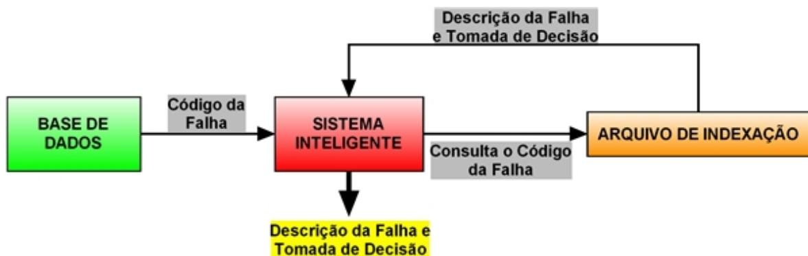
Figura 5.10: Interação do arquivo de falhas no processamento inteligente do sistema.
