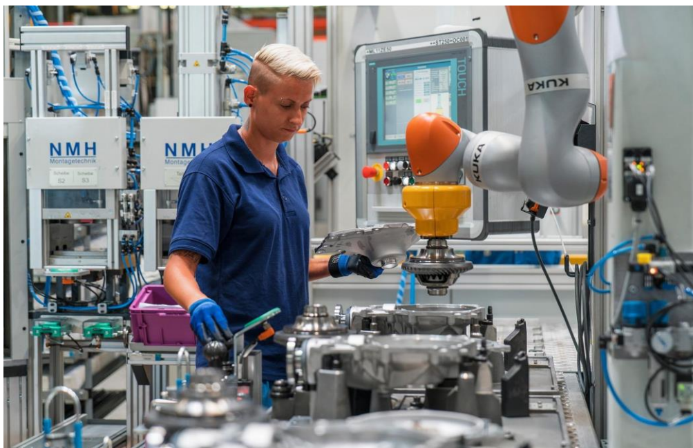
Figura 5. Colaboração homem-robô na montagem de transmissão de eixos, em uma planta da BMW (SCHILLMOELLER, 2017).
