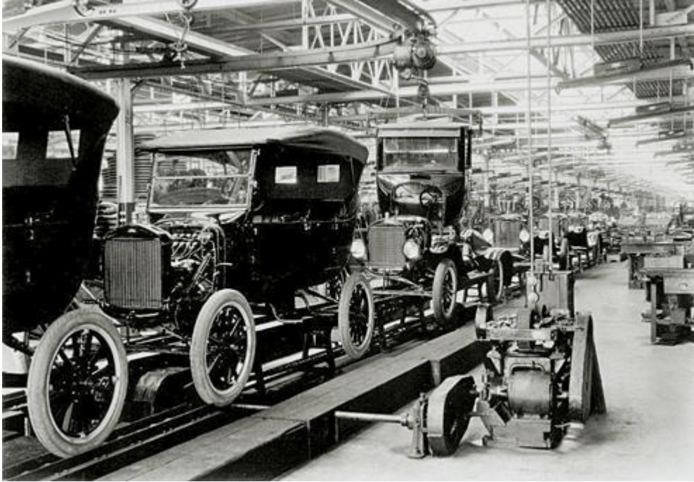
Figura 2. Linha de montagem do Ford modelo T, utilizando esteiras transportadoras.
