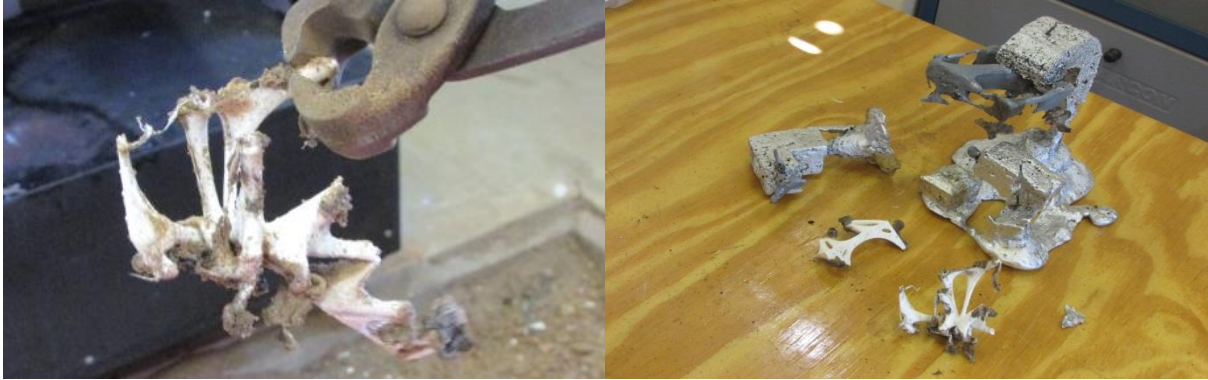
Figura 151: Retiro da peça conformada da caixa de areia. Fonte: Própria
