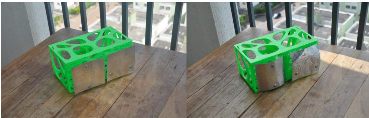
Figura 134: Protótipo de célula responsiva autônoma com acionamento da dilatação diferencial da lâmina de bimaterial – lâmina: papel de 75gr e alumínio para cozinha. Fonte: Própria
