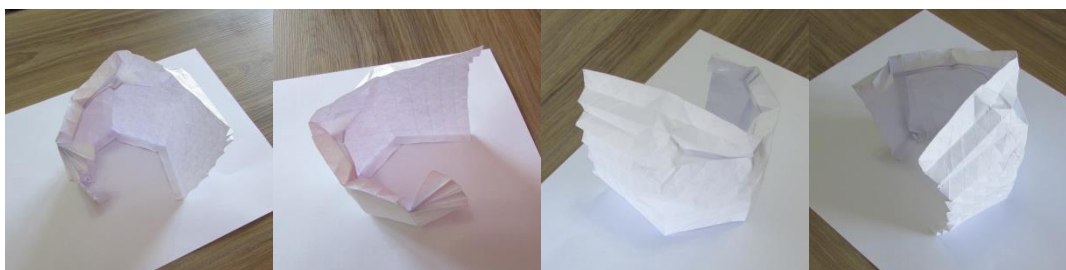
Figura 5: Maquete rápida de papel com dobraduras de formas regulares da superfície de dupla curvatura. Fonte: Própria.
