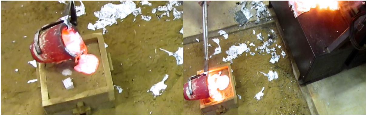
Figura 150: Vertido do alumínio fundido no modelo da peça. Fonte: Própria
