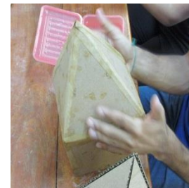
Módulo cortado como peça única reforçado externamente
