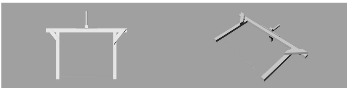
Figura 153: Modelagem do dispositivo de corte a fio quente para o braço robótico industrial. Fonte: Própria
