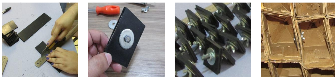
Figura 36: Fabricação dos dispositivos de fixação dos panos. Fonte: Própria
