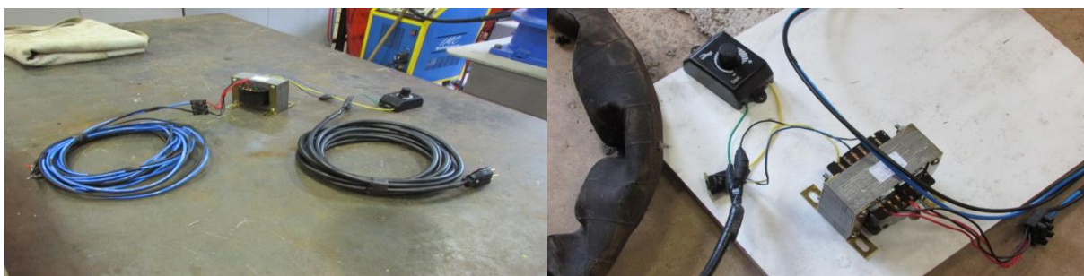
Figura 158: Transformador industrial de 220 volts/110 volts para 12 volts. Fonte: Própria
