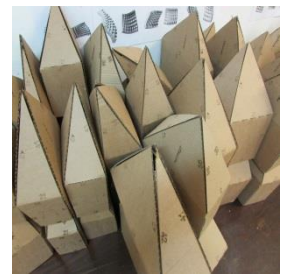
Módulos cortados como peças únicas e reforçados internamente
