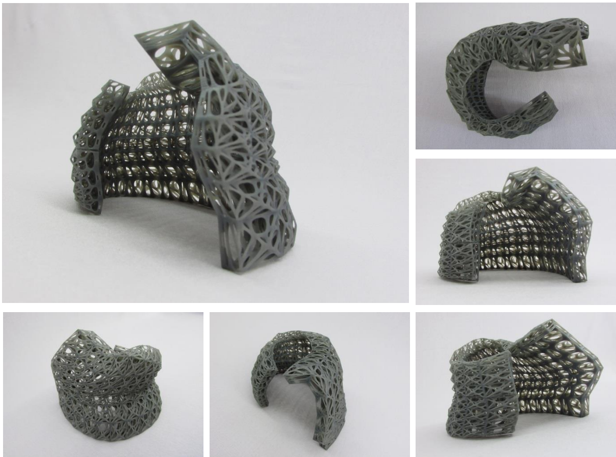
Figura 101: Protótipo do pavilhão construído com a célula estrutural 5 e fabricado com resina pela tecnologia de impressão 3D de processamento por luz direta. Fonte: Própria
