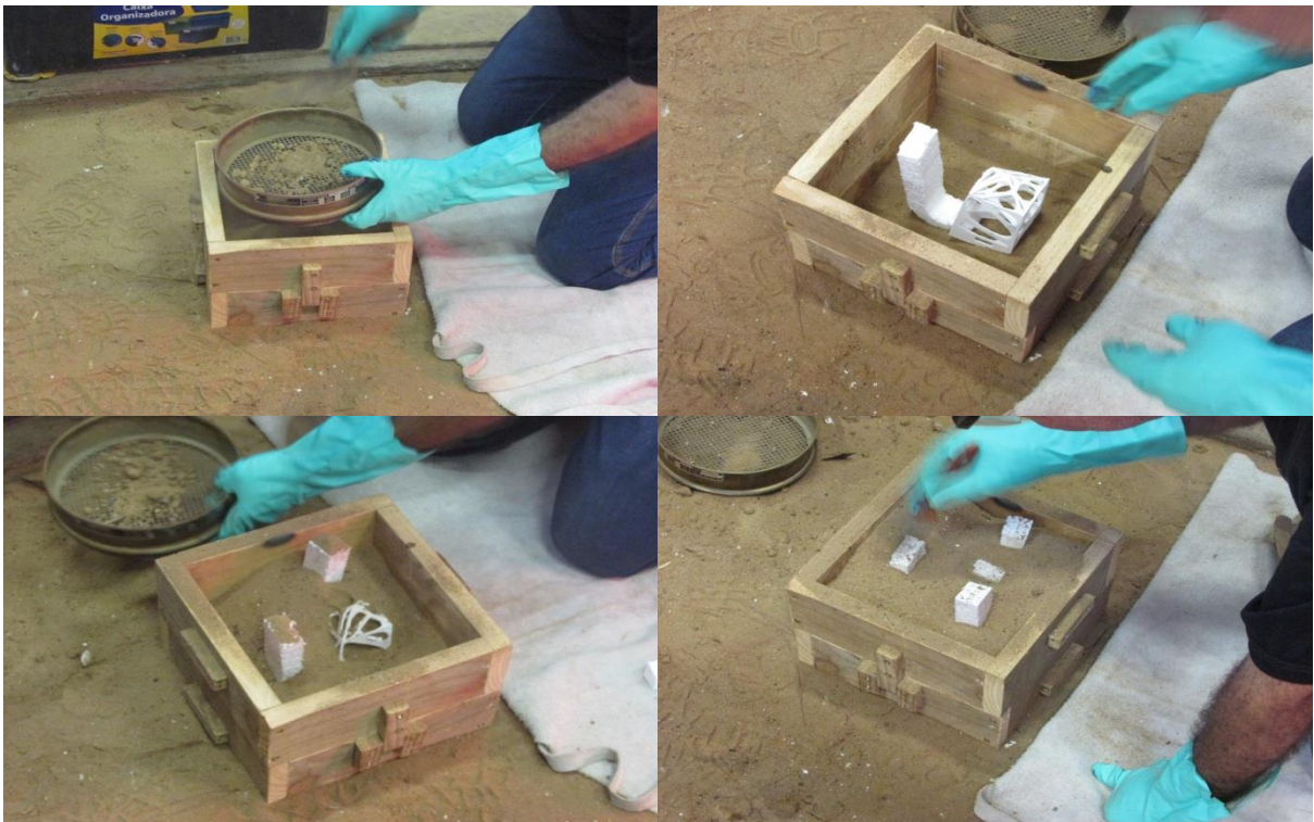
Figura 148: Preparação do modelo da peça para conformação e colocação dos canais para aplicação do material fundido em caixa de areia. Fonte: Própria
