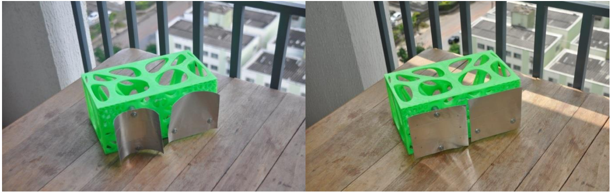
Figura 135: Protótipo de célula responsiva autônoma com acionamento da dilatação diferencial da lâmina de bimaterial – lâmina: papel de 75gr e fita adesiva de alumínio. Fonte: Própria
