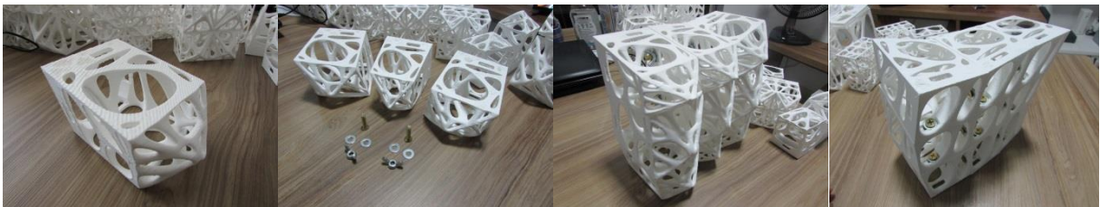
Figura 83: Protótipo de painel torçionado desmontável da célula estrutural 5. Fonte: Própria
