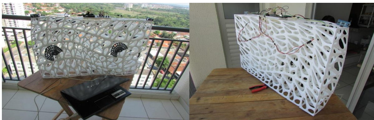
Painel com células responsivas autônomas com acionamento por sensores de distância ultrassônicos
