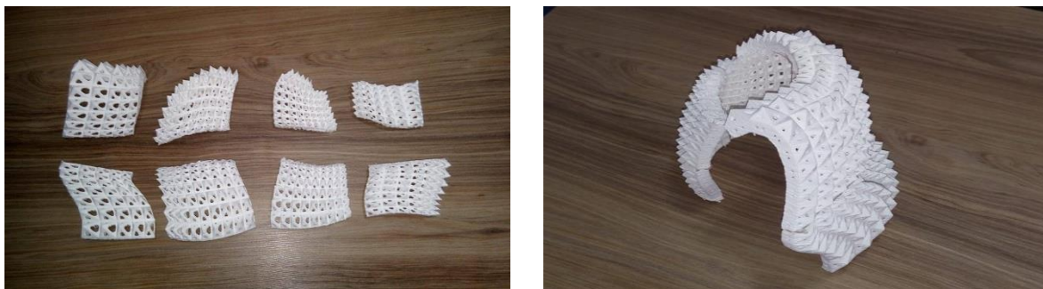
Figura 18: Protótipo 3D físico da parametrização do pavilhão biônico para fabricação digital por adição. Fonte Própria.
