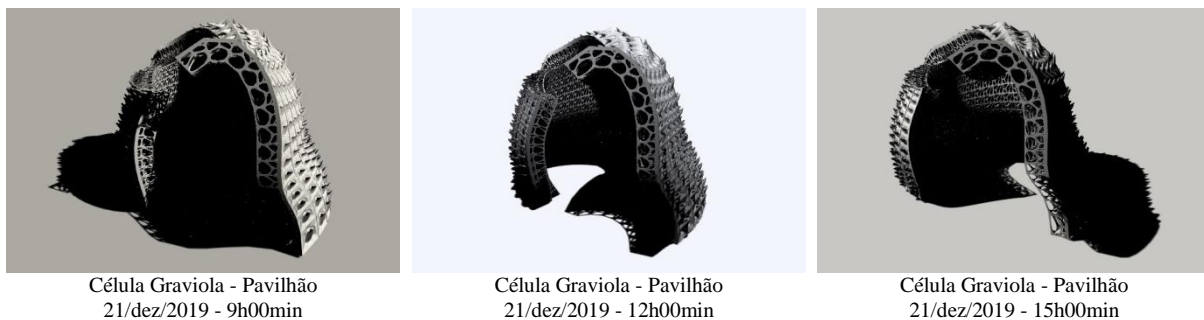
Figura 91: Simulações de projeção de sombras das alternativas para a superfície do pavilhão no dia 21 de dezembro de 2019 nos horários das 9h00min, 12h00min e 15h00min. Fonte: Própria
