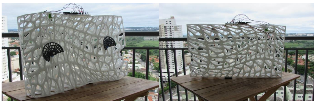
Painel com células responsivas autônomas com acionamento por sensor de temperatura
