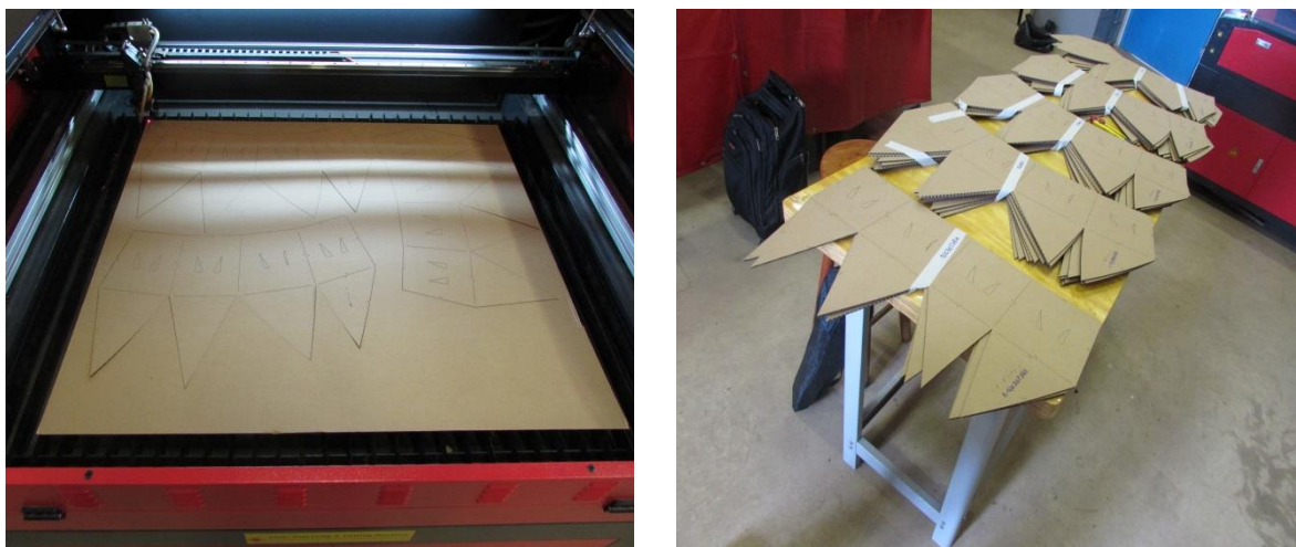
Figura 26: Corte a laser dos módulos em peça única. Fonte: Própria.
