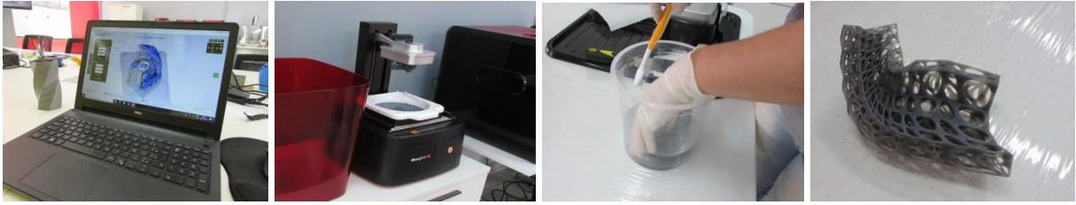
Figura 84: Fabricação por processamento de luz direta em resina utilizando impressora 3D moonray s. Fonte: Própria
