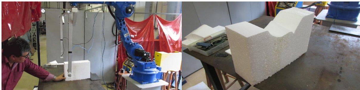
Figura 160: Teste de corte livre com controle manual de isopor com o robô yaskawa motoman – hp20d a20 . Fonte: Própria
