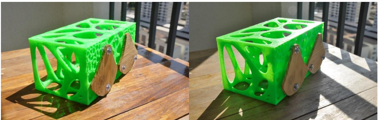
Figura 136: Protótipo de célula responsiva autônoma com acionamento higroscópico – dispositivo móvel em madeira de pinus. Fonte: Própria
