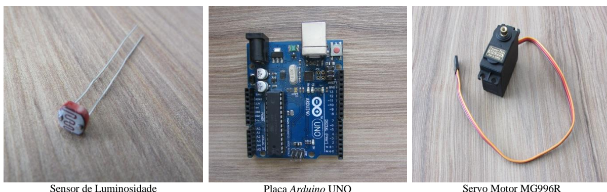
Figura 127: Unidades do sistema robótico da célula responsiva com controle por sensor de luminosidade. Fonte: Própria
