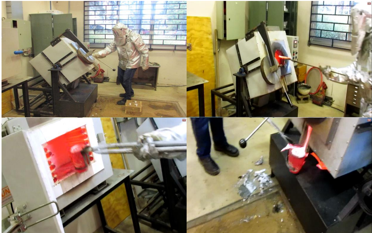
Figura 149: Retirada da vasilha e vertido do alumínio fundido. Fonte: Própria
