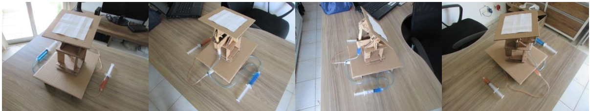
Figura 107: Sistema do dispositivo de impulso para a rotação dos eixos para realizar a orientação da parte móvel da célula. Fonte: Própria
