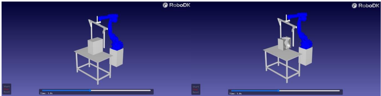
Figura 155: Simulação computacional de corte a fio quente utilizando o software robodk de modelo de peça de forma simples. Fonte: Própria
