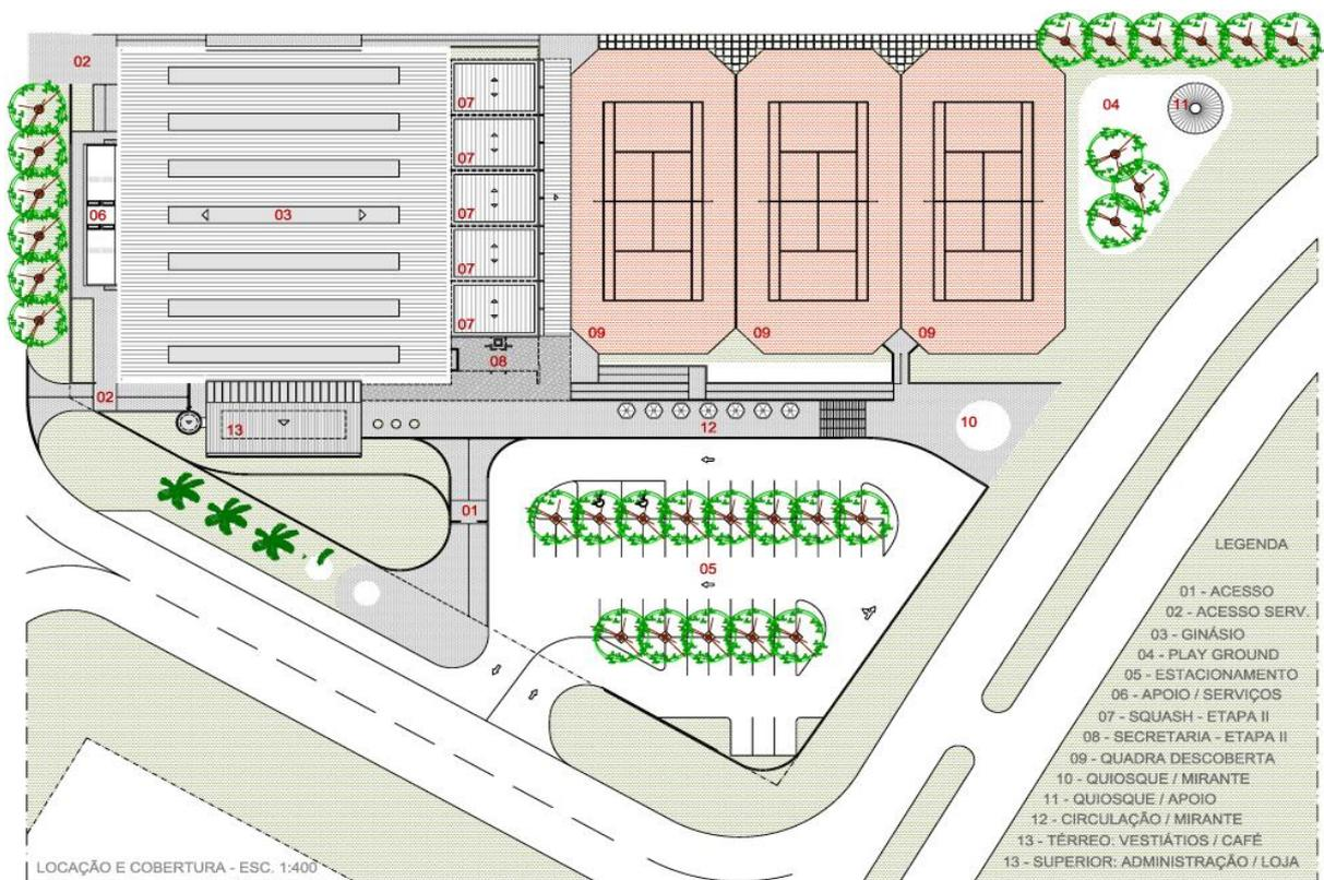
**Figura 4** - Planta de locação do Clube de Tênis e Squash - CATS, DF, com 1.917m<sup>2</sup> de área construída.
