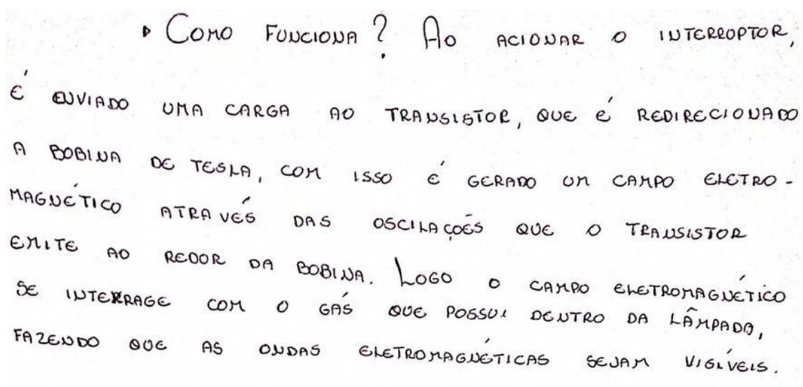
► COMO FUNCIONA? AO ACIONAR O INTERRUPTOR, É ENVIADO UMA CARGA AO TRANSISTOR, QUE É REDIRECIONADO A BOBINA DE TESLA, COM ISSO É GERADO UM CAMPO ELETROMAGNÉTICO ATRAVÉS DAS OSCILAÇÕES QUE O TRANSISTOR EMITE AO REDOR DA BOBINA. LOGO O CAMPO ELETROMAGNÉTICO SE INTERAGE COM O GÁS QUE POSSUI DENTRO DA LÂMPADA, FAZENDO QUE AS ONDAS ELETROMAGNÉTICAS SEJAM VISÍVEIS.
