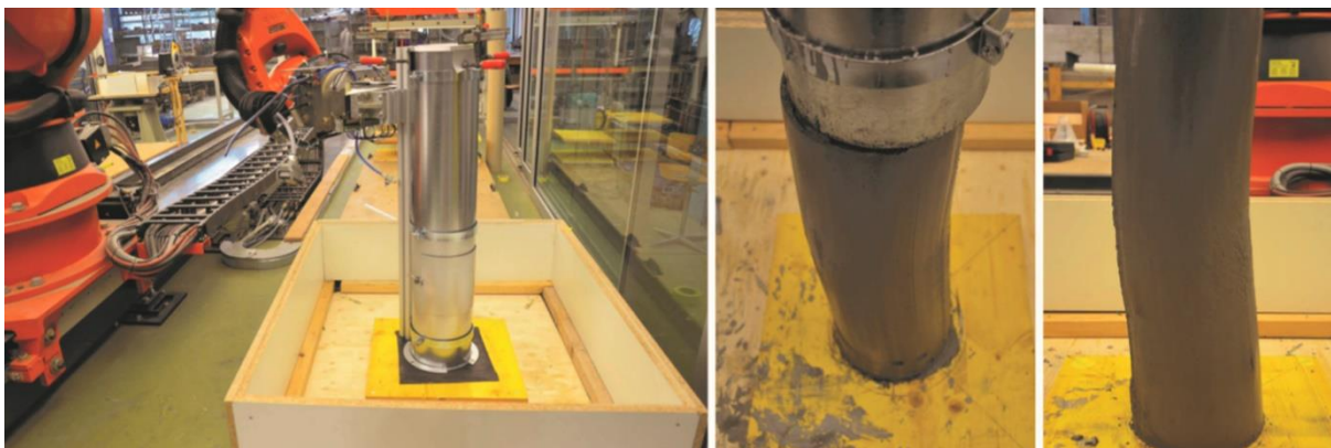
Figura 9 – Técnica de molde deslizante controlado roboticamente para fabricação de concreto.
