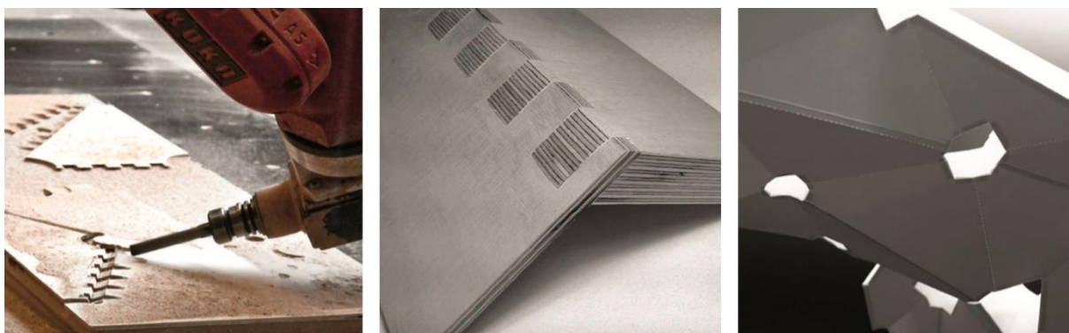
Figura 15 – Sistema de encaixe finger-joint roboticamente fabricado em placas de madeira.
