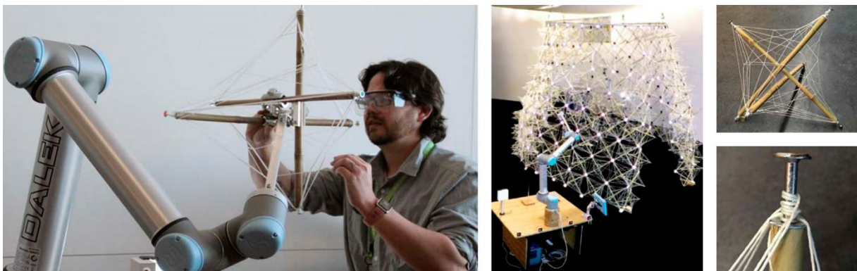
Figura 23 – Colaboração máquina-humano para construção de módulos tensegrity .
