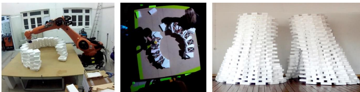
Figura 35 – Comparação entre processo de fabricação robótica e processo de racionalização de trabalho manual por projeção de vídeo, para montagem de torre de blocos em EPS .
