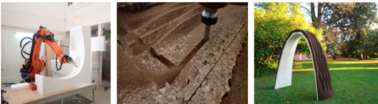
Figura 38 – Processo de fabricação robótica do “ CorkCrete Arch ” do DFL FAUP .
