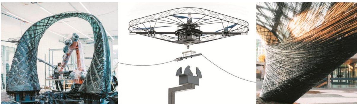
Figura 29 – Processo de entrelaçamento da estrutura em fibras por braço robótico e drone.
