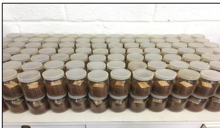
Figura 12. Frascos de vidro com solo, água deionizada e placa suporte prontos para autoclavagem. Foto: Autor, 2019.
