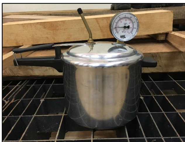
Figura 11. Impregnação dos corpos de prova com o extrato bruto da folha de teca e solvente etanol sob pressão utilizando uma panela de pressão adaptada. Fonte: Autor, 2019.
