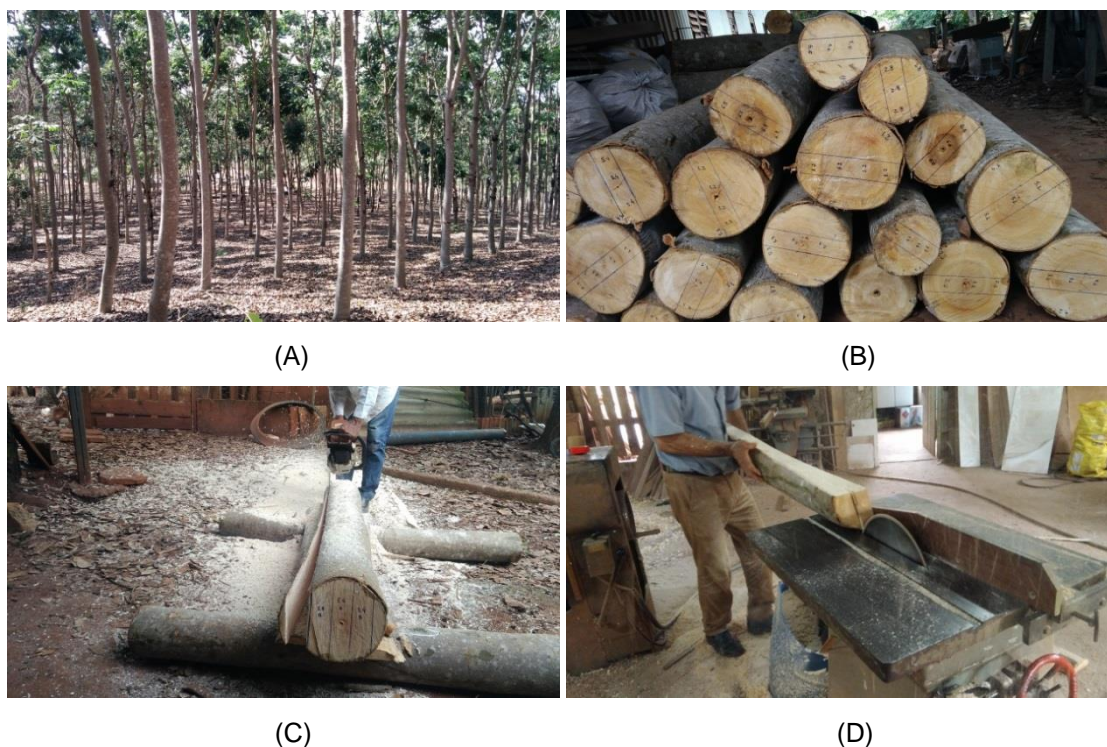
Figura 1. Corte e desdobro da madeira: A) Perfil da floresta de Khaya ivorensis ; B) Toras seccionadas a 1,5 metros e devidamente direcionadas ao desdobro; C) Retirada das costaneiras com o auxílio da motosserra; D) Retirada das tábuas utilizando serra circular.
