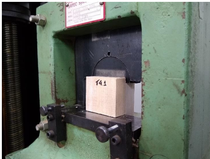
Figura 6. Teste de resistência ao cisalhamento na linha de cola, utilizando maquina universal de ensaios.
