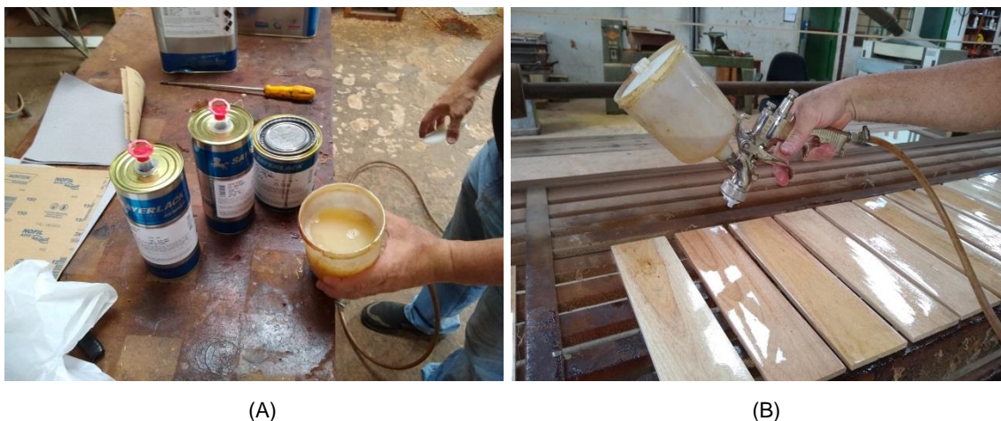
Figura 13. Aplicação de filme de acabamento na superfície da madeira: (A) Preparação do filme de acabamento nas proporções específicas; (B) Aplicação do filme de acabamento com o auxílio de uma pistola.
