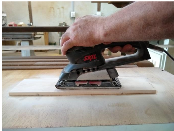
Figura 12. Processo de lixamento da superfície da madeira, utilizando lixadeira semimanual.
