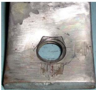
Figura 5.64 – Flange instrumentado
