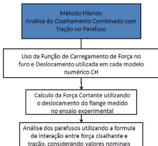
Figura 7.6 – Roteiro utilizado na análise do cisalhamento de parafusos combinado com tração.
