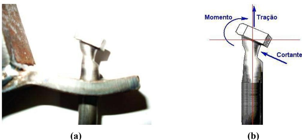
Figura 1.1 – a) Flange e parafuso com abertura de um dente; b) Esforços atuantes no parafuso.
