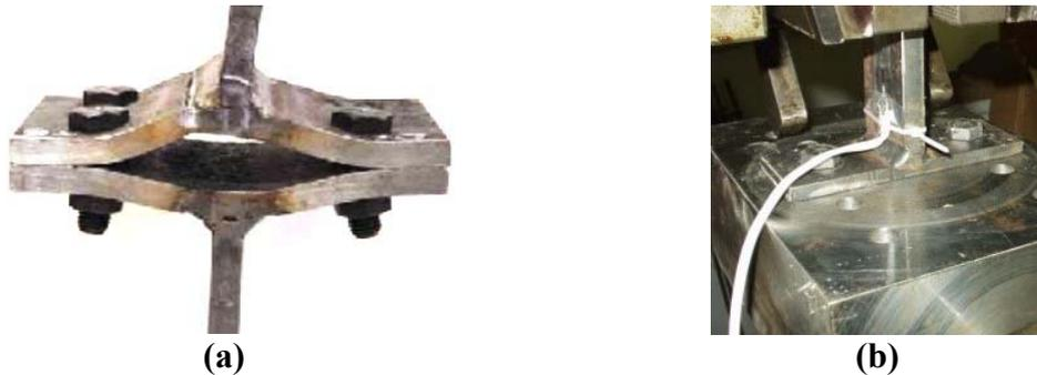
Figura 2.3 – a) Modo de ensaio com duplo T; b) Modo de ensaio com base rígida indeformável.
