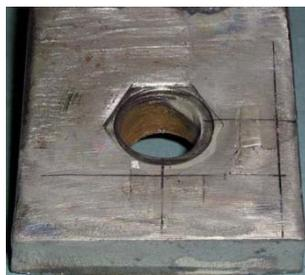
Figura 5.84 – Flange instrumentado
