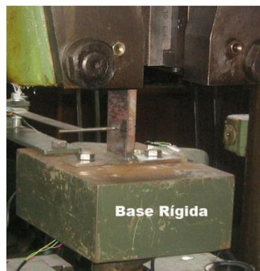
Figura 4.4 – Base rígida utilizada nos ensaios dos perfis T-stub.
