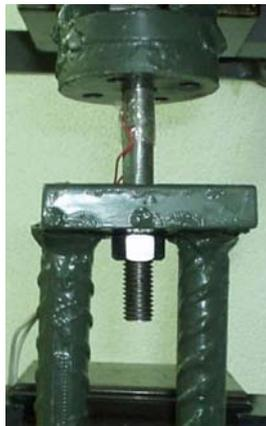
Figura 5.12 – Dispositivo para ensaio dos parafusos.
