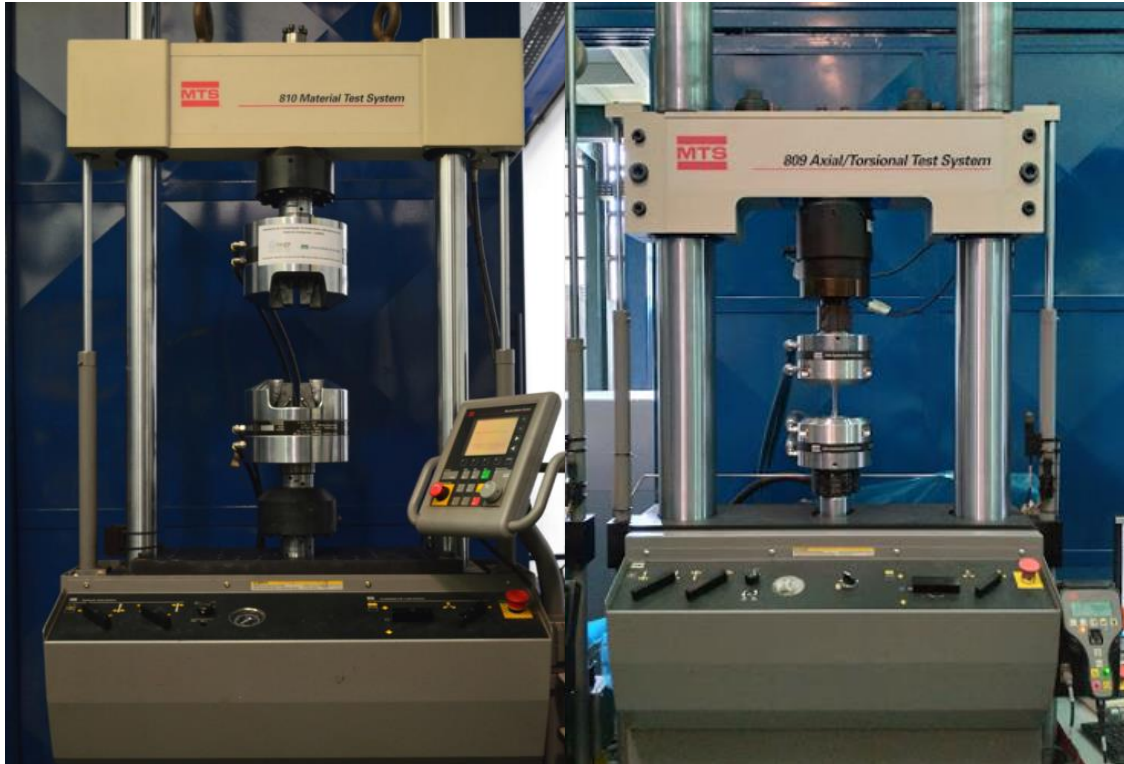
Figura 3.4. Maquinas de ensaio de fadiga MTS - 810 Material test system à esquerda e MTS - 809 Axial/torsional test system à direita.
