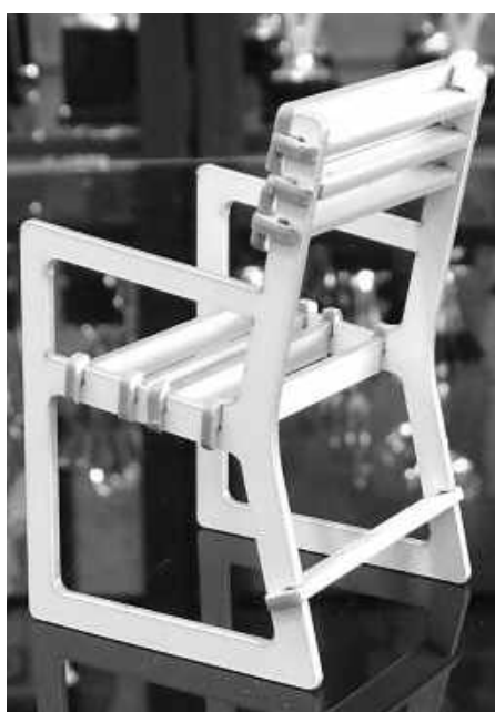
Figura 57 e 58 - Protótipo montado feito a partir de peças cortadas pela máquina a laser.
