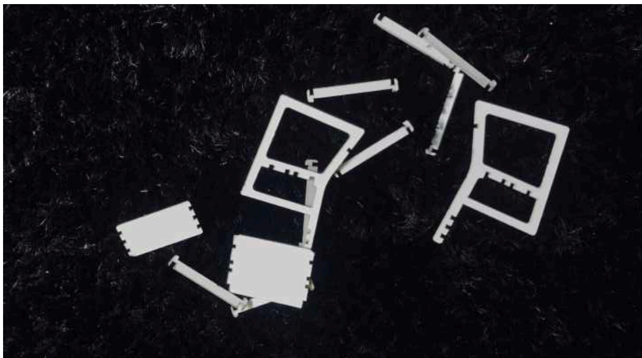
Figura 56 - Peças cortadas para protótipo da Cadeira SSV02 feitas a partir da técnica de corte a laser.
