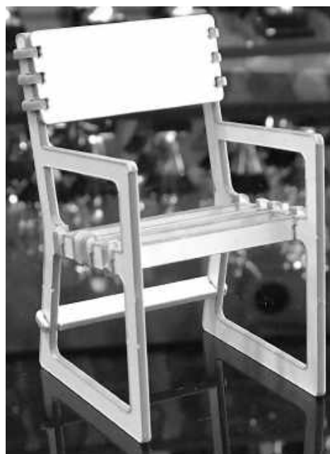
Figura 57 e 58 - Protótipo montado feito a partir de peças cortadas pela máquina a laser.
