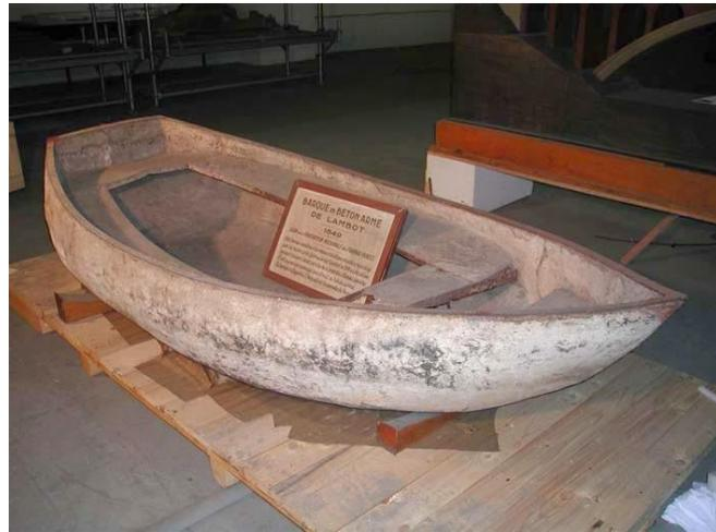
Figura 7. Barco de argamassa armada
