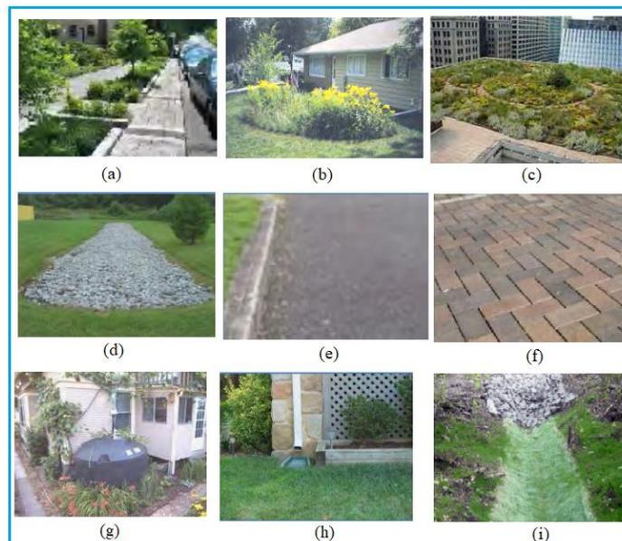
Figura 3.12: LIDs Modeladas no PCSWMM, sendo (a) Células de Biorretenção, (b) Jardins de Chuva, (c) Telhado Verde, (d) Trincheiras Filtrantes, (e) Pavimento Permeável, (f) Pavers, (g) Cisternas, (h) Desconexão no telhado e (i) Sarjeta Verde. (Rossman & Huber, 2016, Adaptado).
