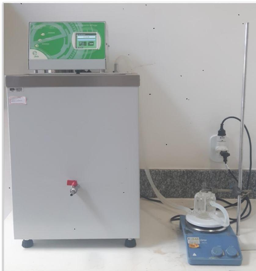
Figura 8 - Equipamentos utilizados para o experimento - método de *Cloud Point*.
