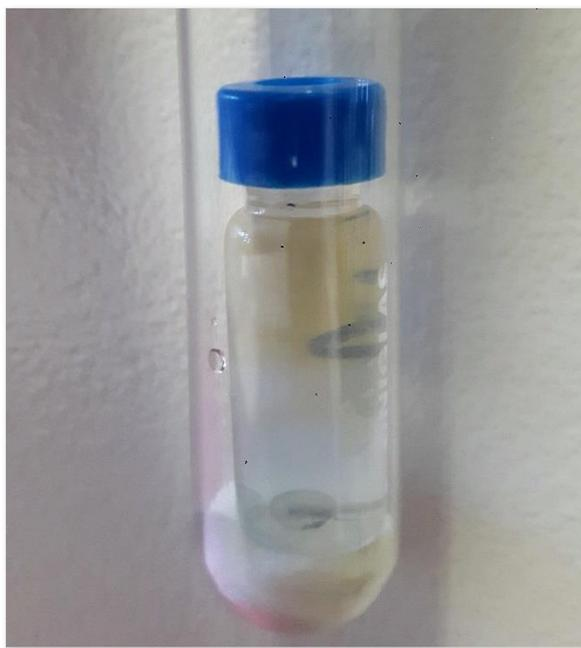
Figura 9 - Separação de fases no vial.
