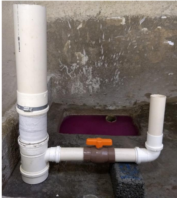
Figura 4: Equipamento para o ensaio de permeabilidade a carga variável
