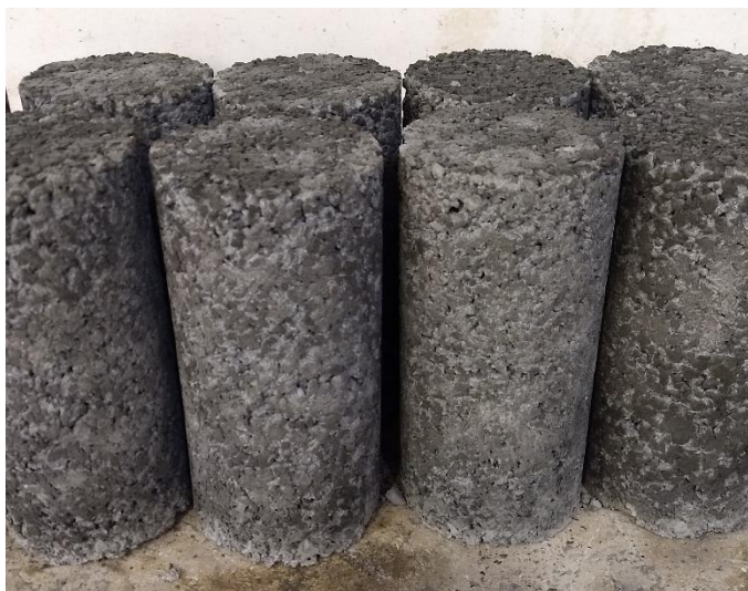
Figura 2: Corpos de prova após serem desmoldados
