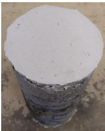
Figura 3: Exemplo de capeamento dos corpos de prova com gesso
