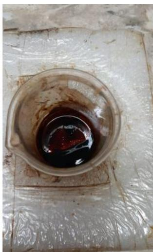
Figura 167 – Amostra de ferrofluido após a etapa de peptização
