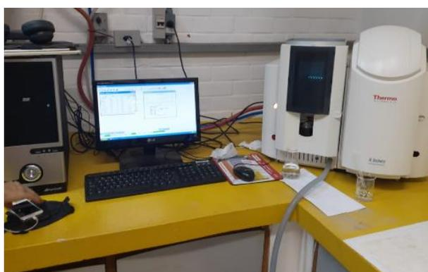
Figura 17 – Espectrofotômetro utilizado para as análises de AAS.
