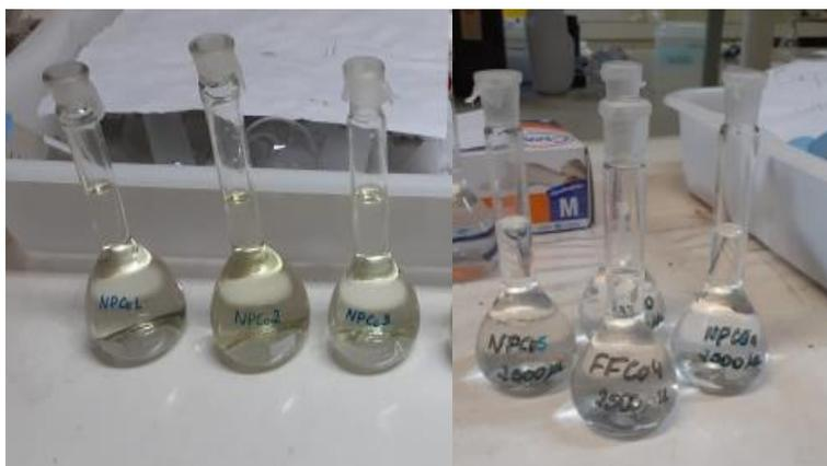
Figura 189- As amostras com coloração visível são a diluição prévia de cada amostra, com concentração mais elevada. As soluções incolores são as amostras injetadas no equipamento.
