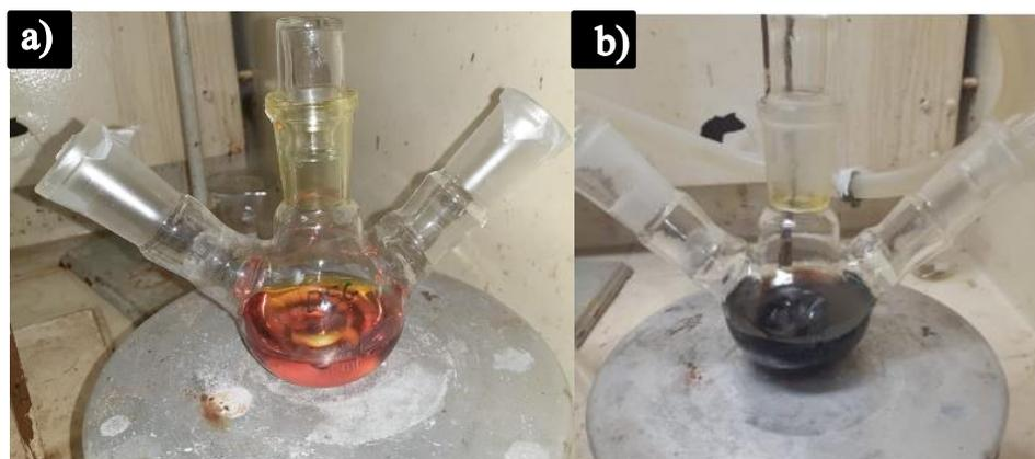
Figura 156 – A solução de cloretos antes (a) e após (b) a mistura da solução básica
