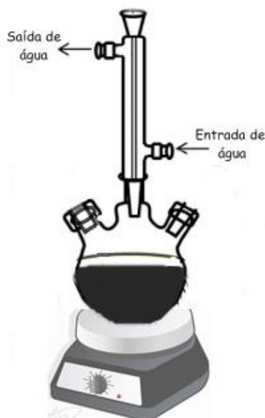
Figura 145 – Modelo esquemático do aparato experimental utilizado nas sínteses
