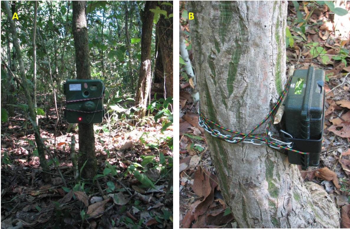
Figura 4: Armadilhas fotográficas fixadas em troncos de árvores. A: Exemplo de armadilha Tigrinus modelo 4.0 C, mais antigo. B: Exemplo de armadilha Tigrinus, modelo 6.0C.
