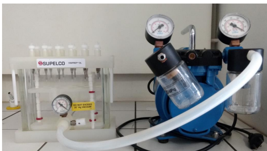
Figura 16: Sistema de eluição manifold utilizado para realizar a eluição dos analitos.
