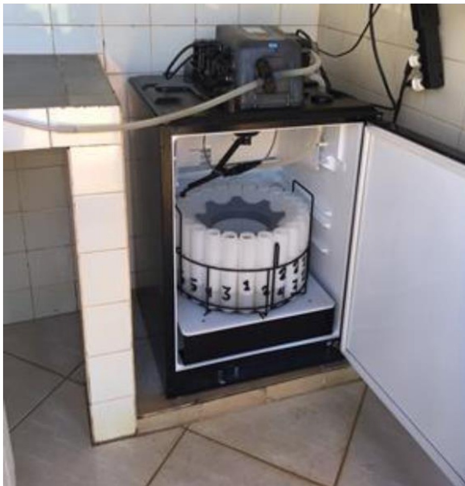
Figura 14: Amostrador automático utilizado pelos técnicos da CAESB para coleta de amostras nas ETEs
