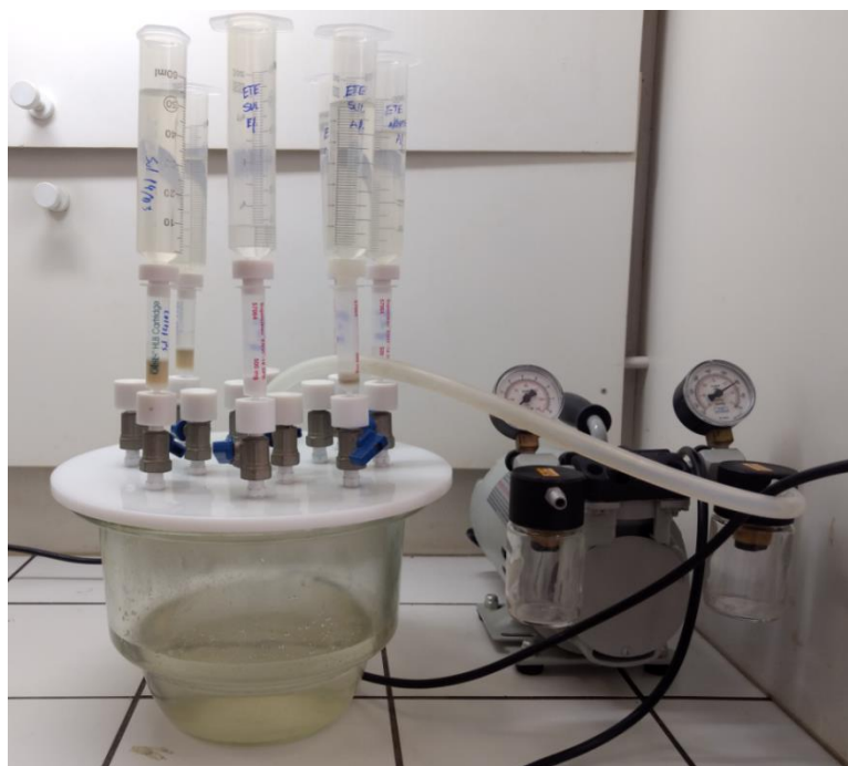
Figura 15: Sistema de extração manifold utilizado para realizar a extração em fase sólida.
