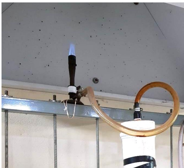
Figura 17 – Chama sustentada durante fase exotérmica da carbonização de Arundo donax .
