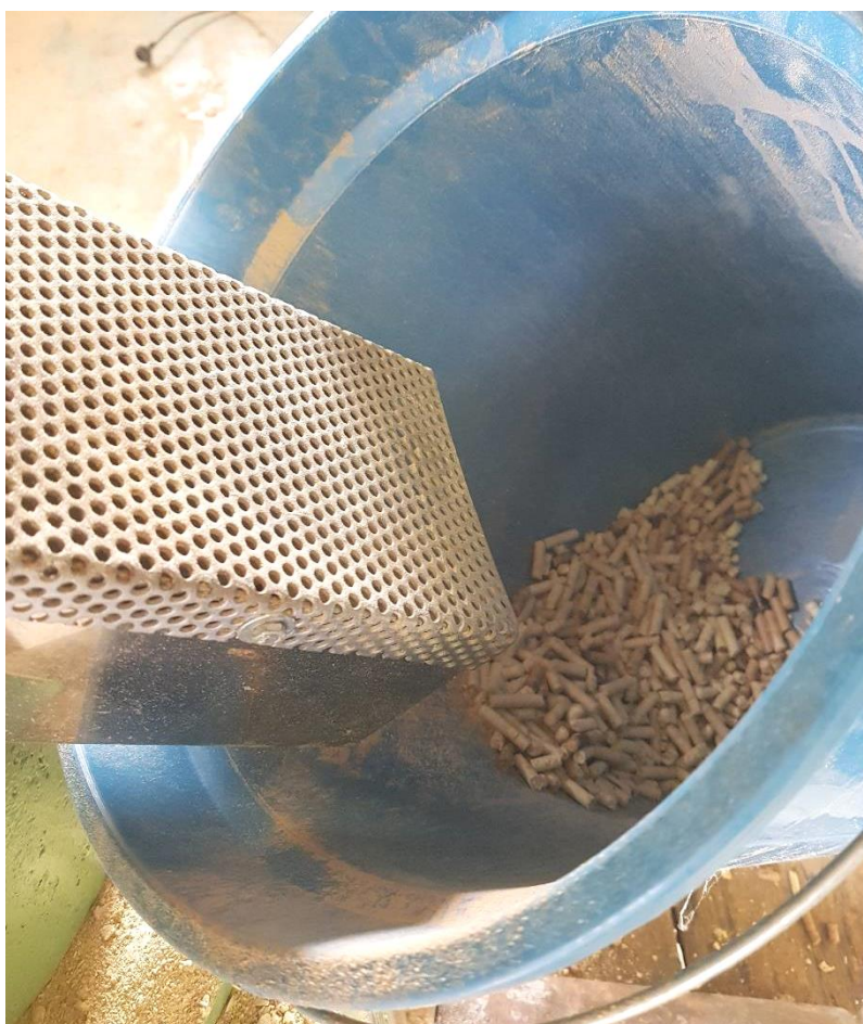
Figura 10 – Péletes de Arundo donax sendo recolhidos na saída do equipamento. Foto: Autor
