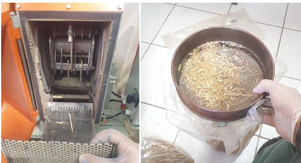
Figura 04 – Moinho de martelos e classificação em peneira do material moído. Fotos: Autor
