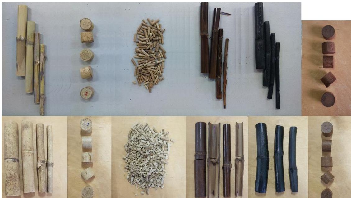
Figura 01 – Tratamentos da esquerda para direita: in natura , briquete, péletes, torreficado, carvão e briquete após torrefação. Na linha superior Arundo donax , e na inferior Phyllostachys aurea .
