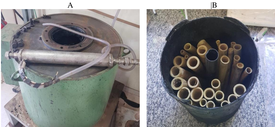
Figura 07 – Reator de carbonização, com a abertura para acomodar até 20 litros de biomassa (A), e recipiente com amostra para carbonização, com cilindro metálico ao centro para abrigar o termopar que monitora a temperatura no interior da amostra (B).
