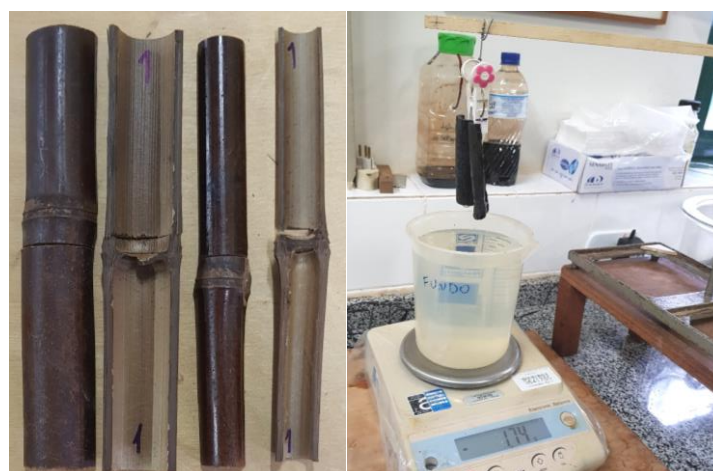
Figura 13 – corpos de prova rachados no sentido longitudinal, e o teste de densidade pelo método de Arquimedes
