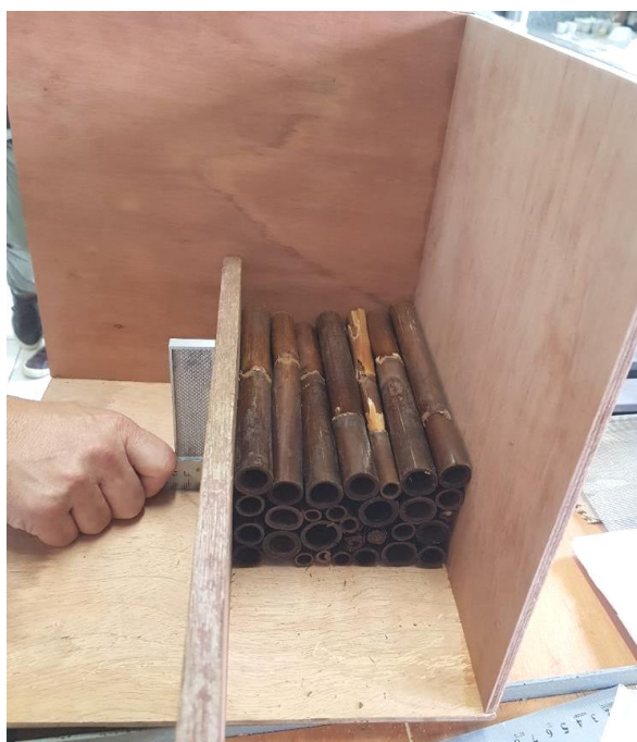
Figura 11 – Triedro confeccionado para medição do volume do granel Foto: Autor
