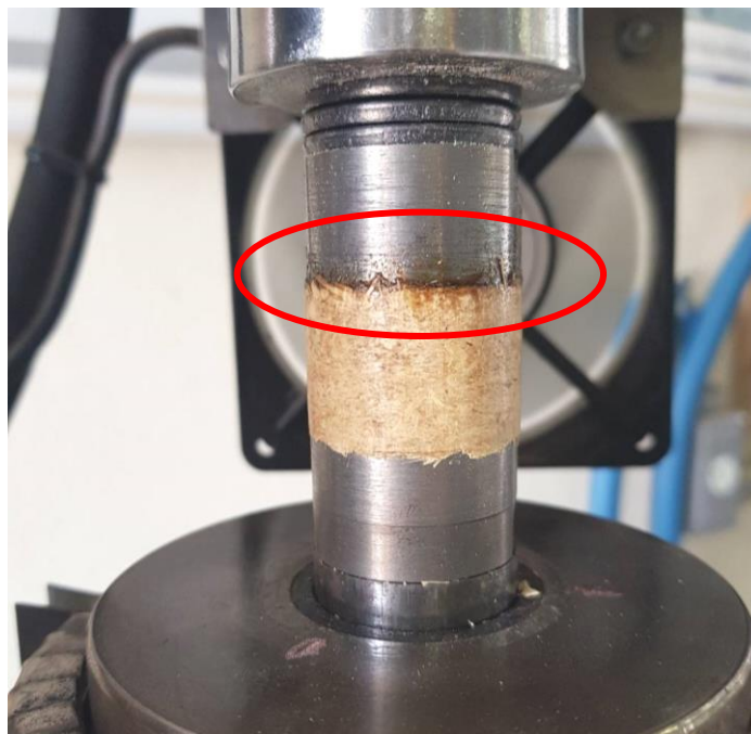
Figura 18 – Detalhe em destaque da resina na parte superior do briquete de Arundo donax Foto: Autor
