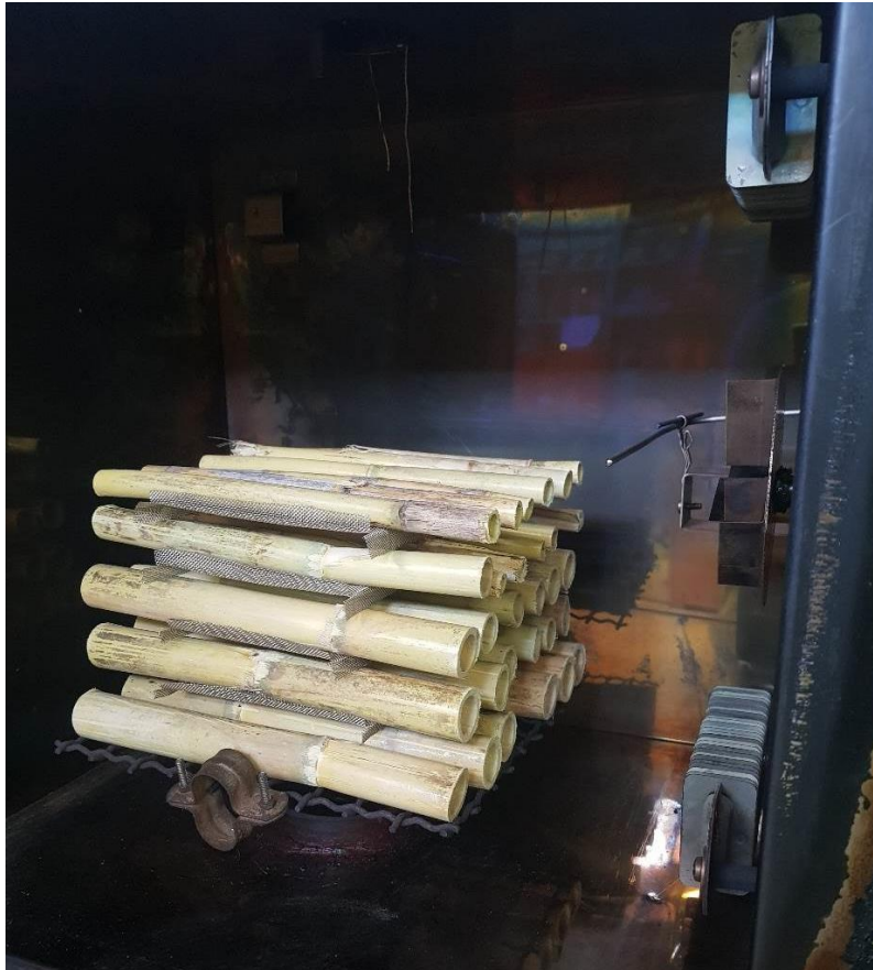
Figura 06 – Interior do reator de torrefação com amostra de Arundo donax sobre o pedestal da balança, e à direita as resistências elétricas acima e abaixo e o termopar de controle de temperatura entre elas.
