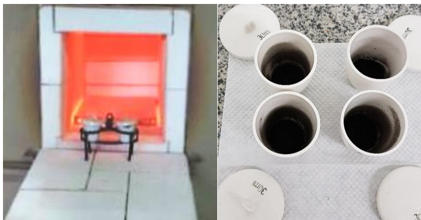
Figura 14 – Ensaio de Matérias voláteis em forno mufla, e o produto resultante composto de carbono fixo e cinzas.
