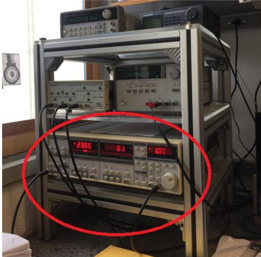
**Figura 3.7:** Amplificador Lock-in comercial (SR830 DSP lock-in amplifiers) utilizado no Laboratório de Física PUC Rio
