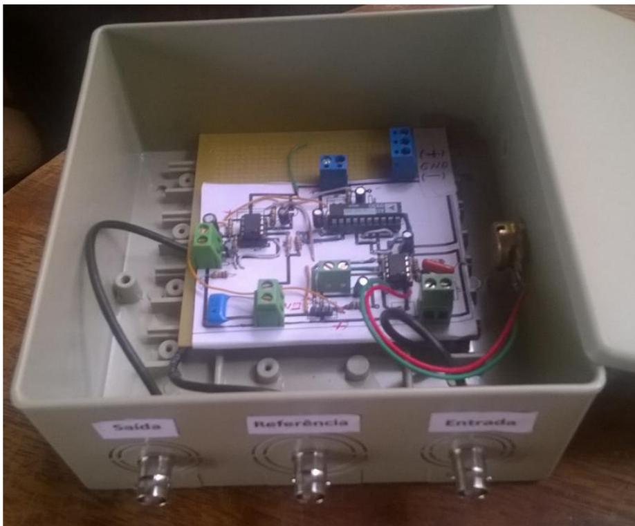
**Figura.4.1** Primeira versão do circuito, protótipo do dispositivo Lock-in montado para testes.
