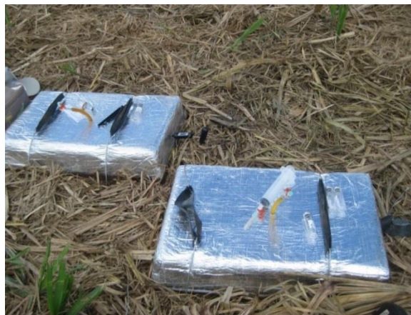
Figura 8. Câmaras estáticas para realização da coleta de N 2 O no solo. Fonte: Sousa (2016).
