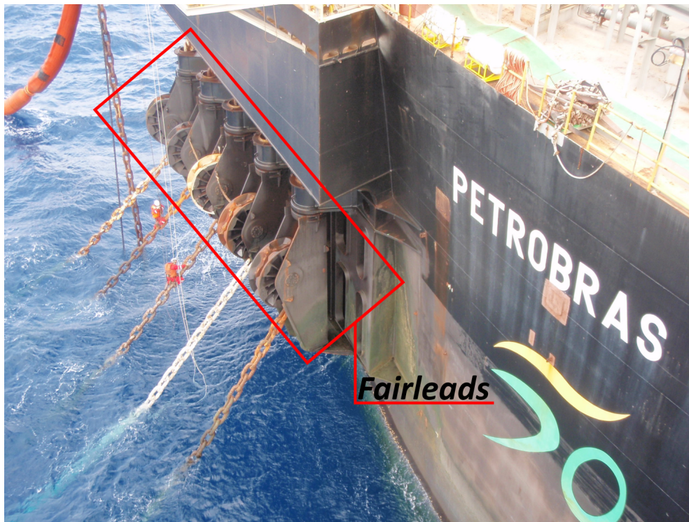
Figura 3.14: Fairleads do FPSO P-50 da Petrobras.
