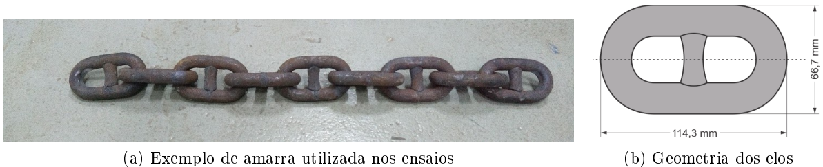
Figura 3.21: (a) Exemplo de amarra utilizada nos ensaios e (b) geometria típica dos elos.
