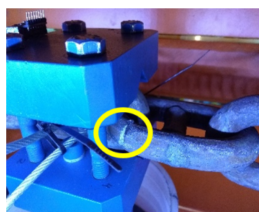
(a) Falha de uma da amarra por OPB
