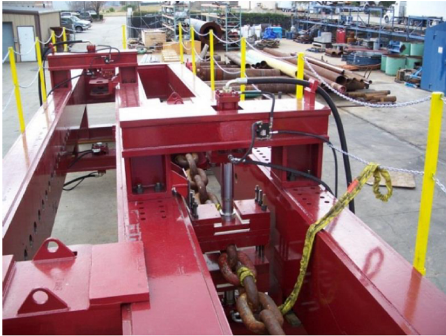
(b) Máquina de ensaio para amarras maiores (2 baías independentes)
