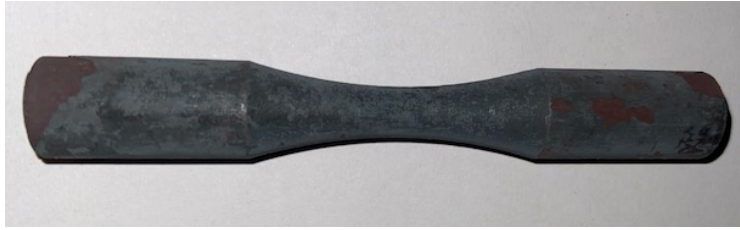
Figura 3.6: Exemplo de corpo de prova padrão utilizado em um dos ensaios de fadiga.
