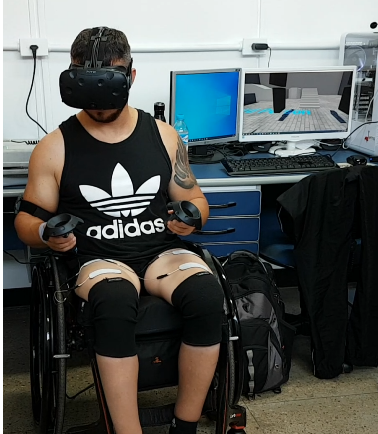
Figura 4.33: Voluntário com lesão medular utilizando o sistema de realidade virtual desenvolvido. O voluntário está utilizando o HMD do HTC Vive na cabeça, os controles do HTC Vive nas mãos e uma IMU para estimativa da velocidade no braço direito. O que o voluntário visualiza na tela do HMD também é mostrado em tempo real no monitor do computador ao lado.
