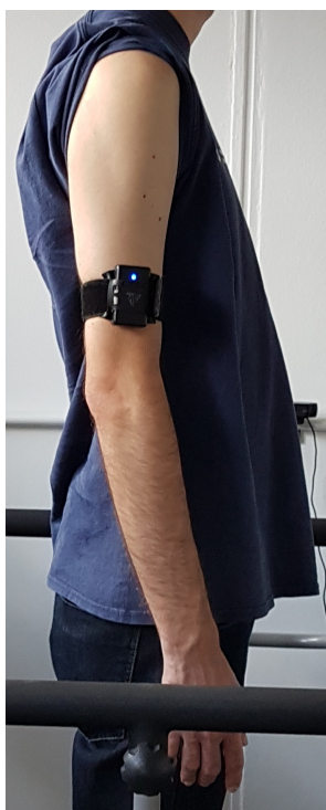
Figura 4.32: IMU posicionada no braço direito do usuário
