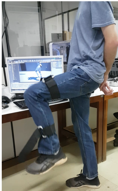
Figura 4.27: Rastreamento das pernas do avatar com orientação das IMUs
