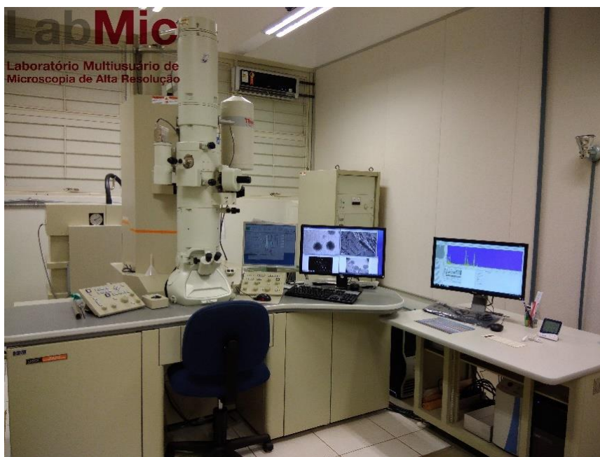
Figura 20. Foto do microscópio utilizado para realizar as medidas de MET
