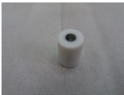
Figura 22. Eletrodo de trabalho utilizado de carbono reticulado vítreo revestido em Teflon.
