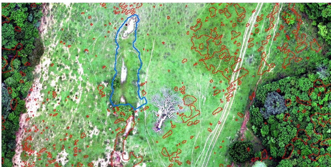
Figura 7: Diferença de formato entre objetos gerados no MDS considerados a partir da verificação em campo como dolina (azul) e os demais considerados como espúrios (vermelho). Os objetos em vermelho possuem um produto da razão perímetro/área bem superiores às dolinas observadas em campo.
