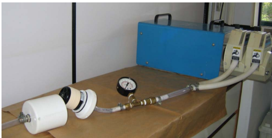
Figura E.1 – Sistema de filtração Filta Max e bomba peristáltica
