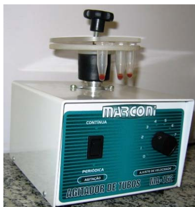
Figura E.8 – Tubos no agitador vortex na etapa de dissociação dos oocistos de Cryptosporidium das esferas magnéticas ( beads )
