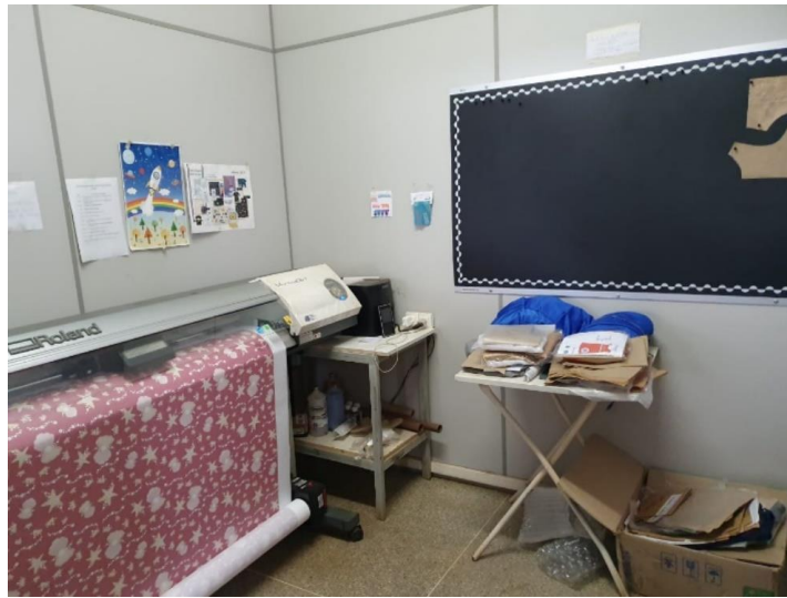
Figura 10 – Impressora Plotter de Sublimação – Estamparia
