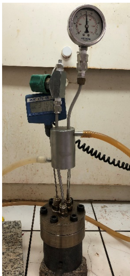
Figura 23. Reator para hidrocraqueamento. Fonte: Do Autor.
