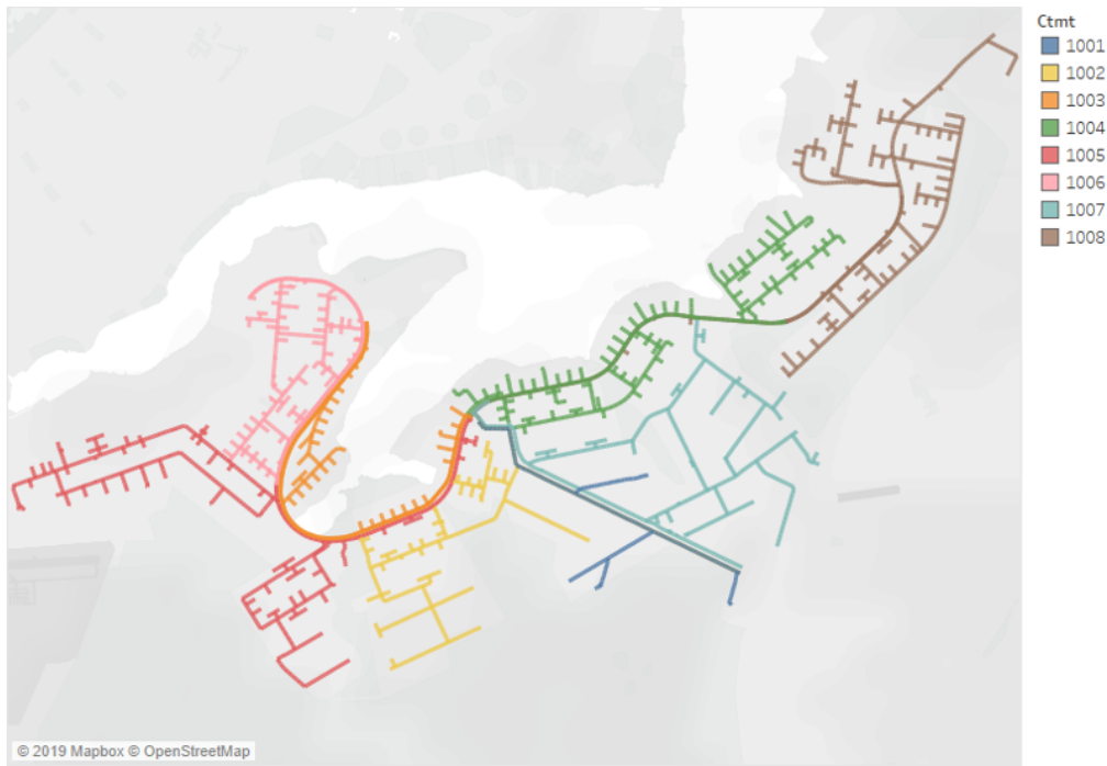
Figura 4.4: Alimentadores que compõem a subestação 10.
