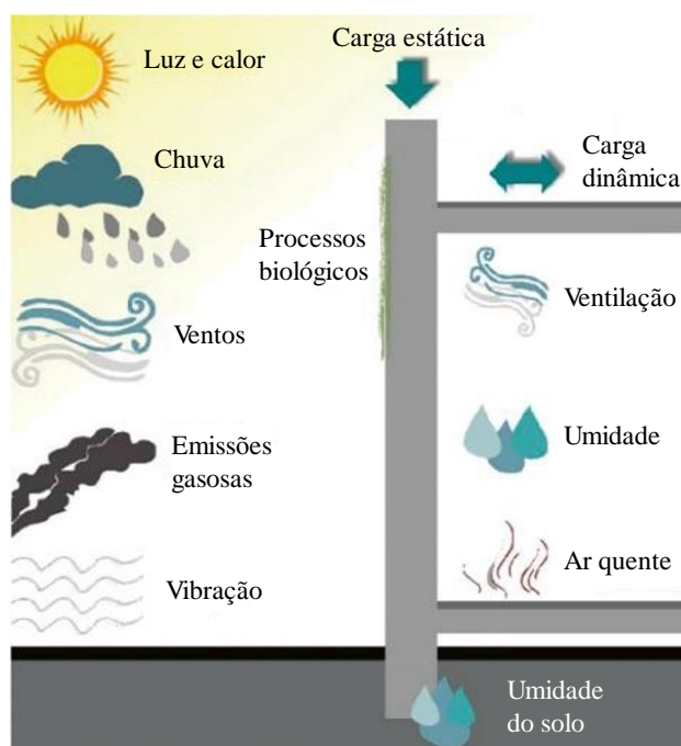
Figura 2. 2 – Solicitações em sistema de vedação vertical (Kazmierczak et al. , 2016)
