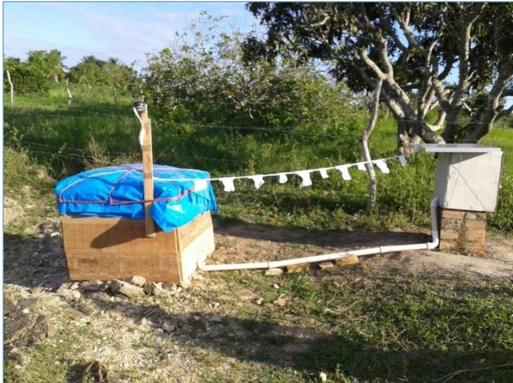
Figura 8 – Registro fotográfico da estação sismológica instalada. O sismômetro encontra-se posicionado dentro da caixa isolada de madeira, e registrador acomodado sobre a pilha de tijolos coberto por camada de areia, com caixa de proteção.
