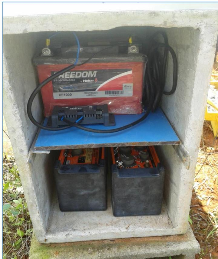
Figura 7 – Registro fotográfico da acomodação do sensor registrador e da bateria armazenadora de energia obtida através de painel solar.
