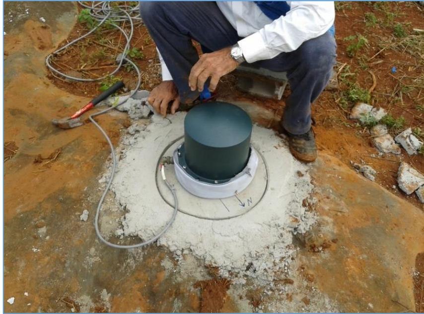
Figura 6 – Fotografia tirada durante a instalação e posicionamento do sismômetro de uma determinada estação sismográfica da Rede Geoterm sobre base de concreto e afloramento de rocha, em região isolada de ruído.
