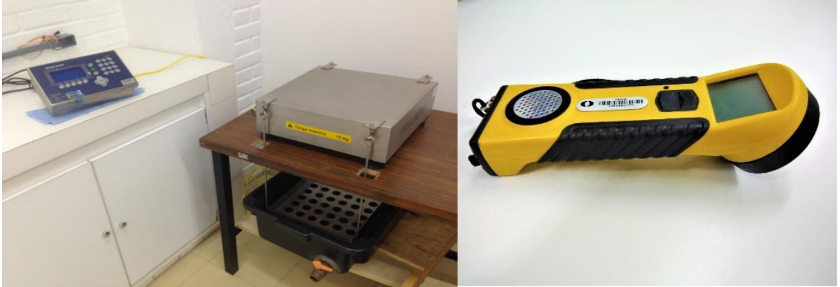
Figura II.7: À direita: Balança de pesagem industrial utilizadas para pesagem das amostras. À esquerda: Susceptibilímetro portátil KT-10 utilizado para a obtenção dos dados de susceptibilidade magnética.
