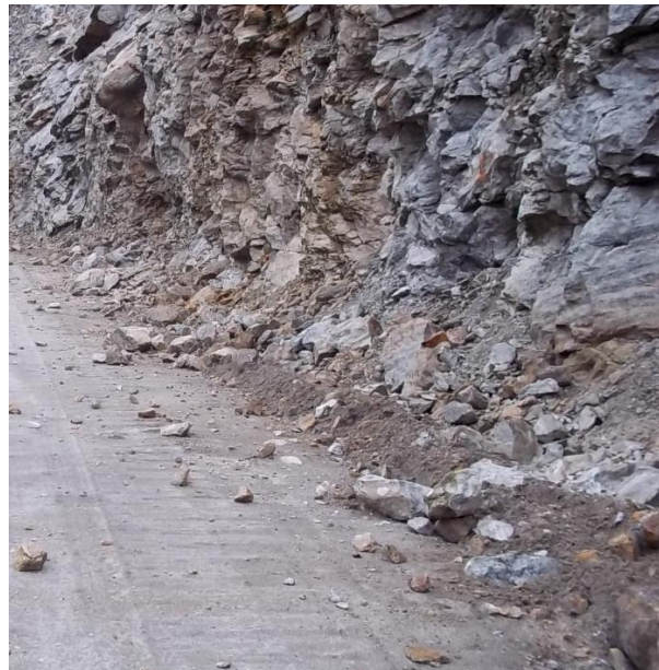
Figura 4.15. Maciço apresentando espaçamento médio entre as descontinuidades de 18cm. Classificação E4, ou seja, próximas.
