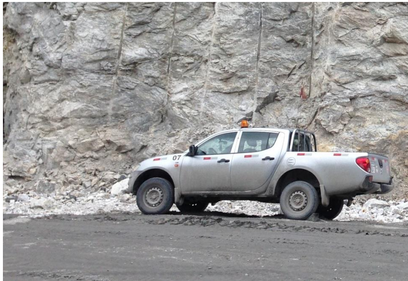
Figura 4.24. Frente de lavra indicando as características do maciço submetidos a fogo (atentar meia cana).
