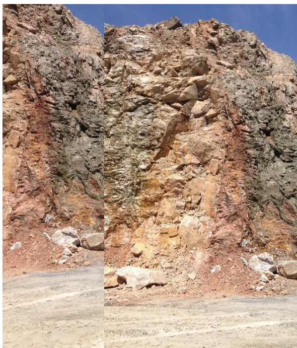
Figura 4.10. Carbonatito de Falha, mediamente alterado e com alto grau de fraturamento.
