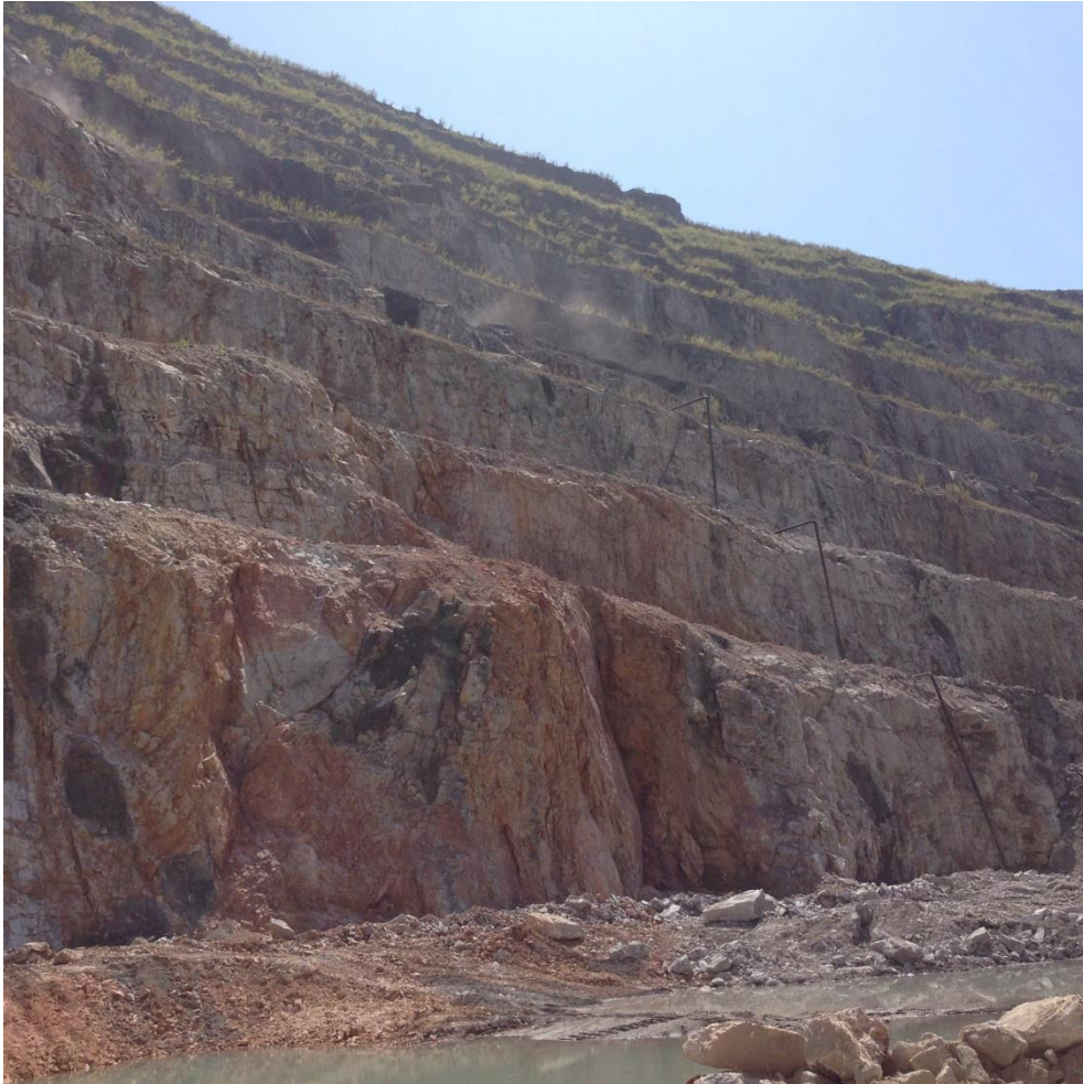
Figura 4.25. Frente de lavra indicando as características da região de ocorrência de Xenolitos.
