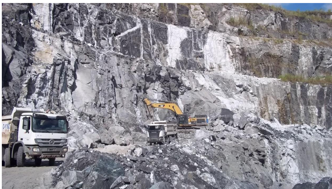
Figura 4.5. Fotografia de frente de escavação mecânica em zona de xenólito típica.
