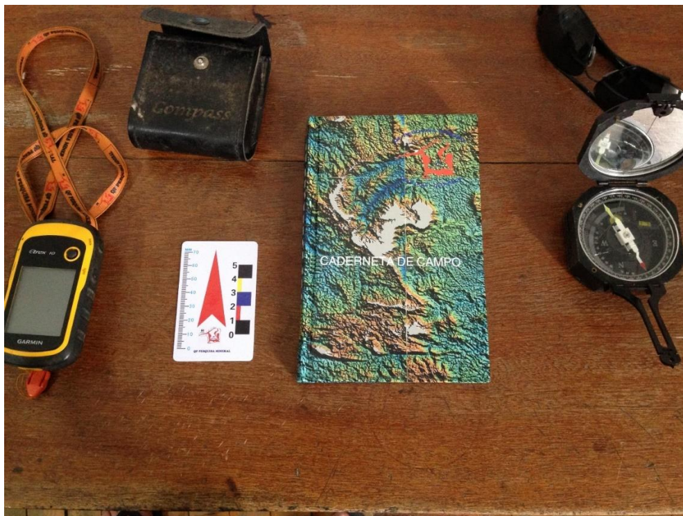
Figura 3.13. Ferramentas de campo utilizadas durante o trabalho de mapeamento geológico-geotécnico. Com destaque para o aparelho GPS (Global Position System), bússola geológica (modelo Brunton), além de caderneta de campo e escala de referência.
