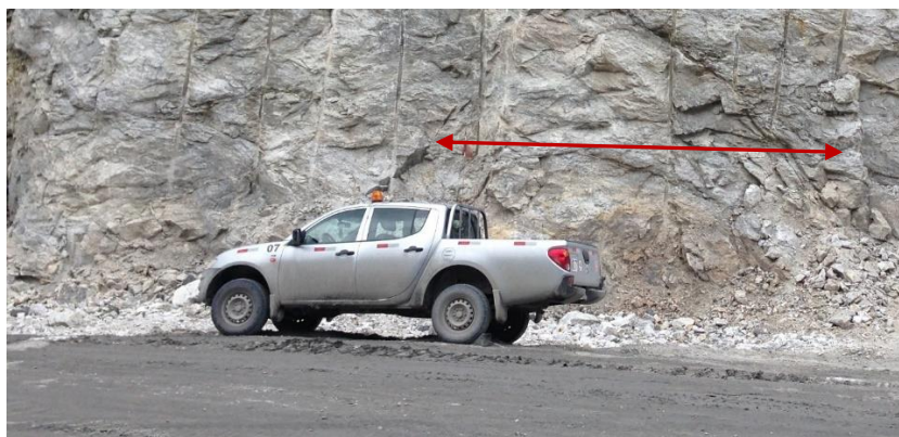
Figura 4.16. Maciço apresentando espaçamento médio entre as descontinuidades de 6 m. Classificação E1, ou seja, muito afastadas.
