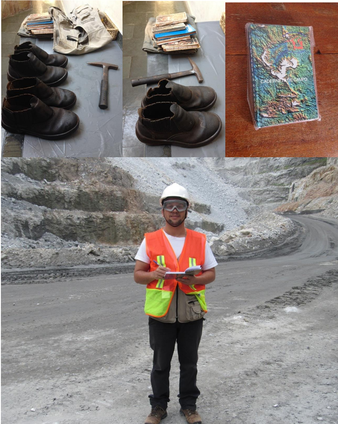
Figura 3.14. Ferramentas de campo utilizadas durante o trabalho de mapeamento geológico-geotécnico. Com destaque para o martelo geológico (modelo Estwing), cadernetas de campo de referência, além de caderneta de campo para o levantamento na Mina e equipamentos de segurança individual exigidos na Mina.
