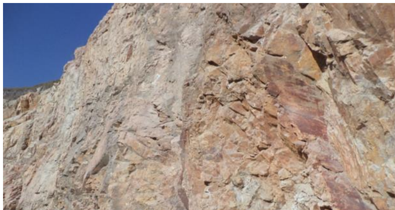
Figura 4.27. Frente de lavra indicando as características da região de Zona de Cisalhamento.
