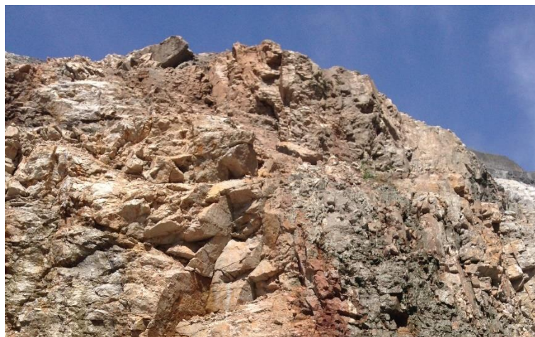
Figura 4.21. Maciço rochoso de Zona de Falha apresentando paredes da descontinuidade rugosa recortada.
