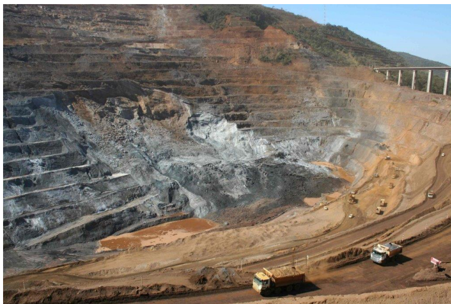
Figura 2.2. Exemplo de ruptura global em talude de mineração (h ~ 90m), (Mina Gongo Soco, 2013).
