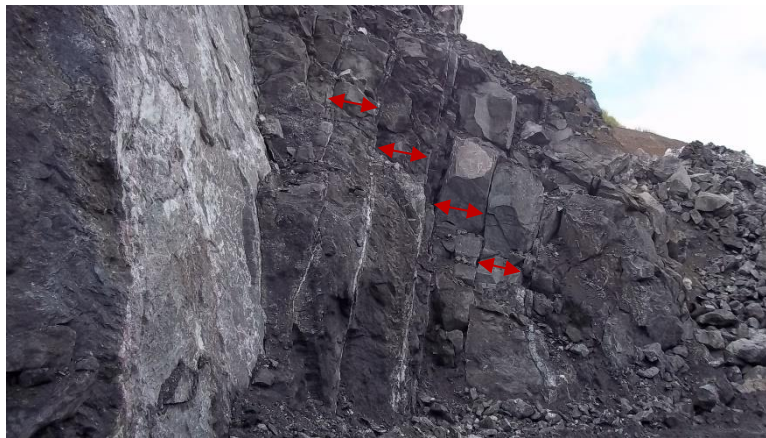
Figura 4.14. Espaçamento das descontinuidades medido em relação à perpendicular.
