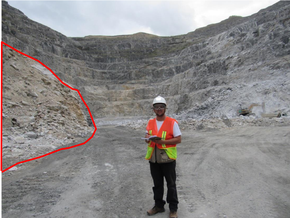
Figura 4.26. Frente de lavra indicando as características da região de Zona de Cisalhamento.
