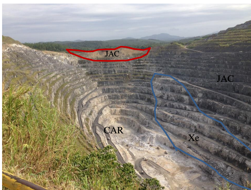
Figura 4.12. Imagem parcial da Mina destacando contatos geológicos entre os litotipos carbonatito (CAR), xenólitos (Xe) e Jacupiranguito (JAC).
