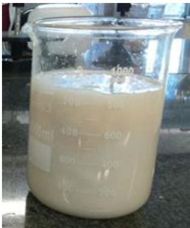
Figura 2.11: Suspensão de CMF após processamento em moinho Mazuko.
