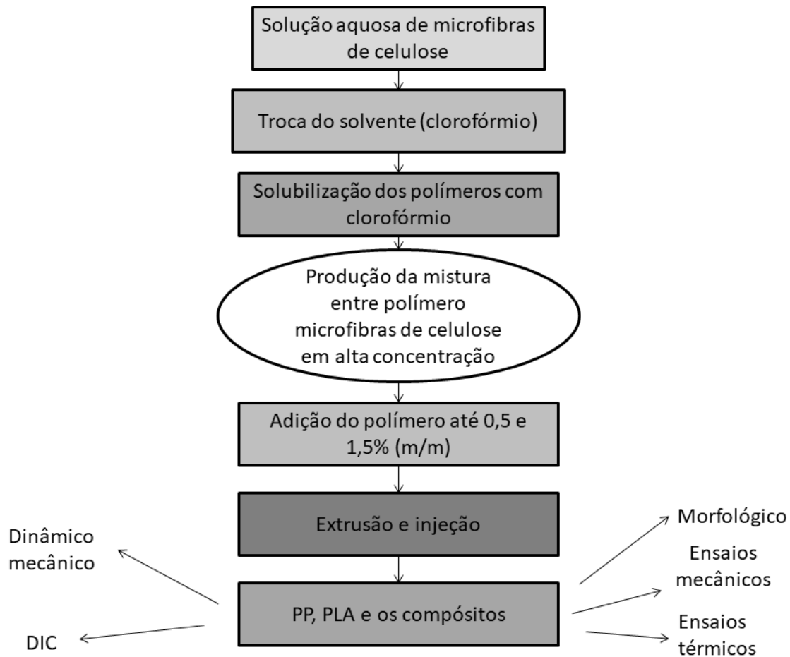
Figura 2.9: Fluxograma esquemático da metodologia empregada para produção e caracterização dos compósitos.
