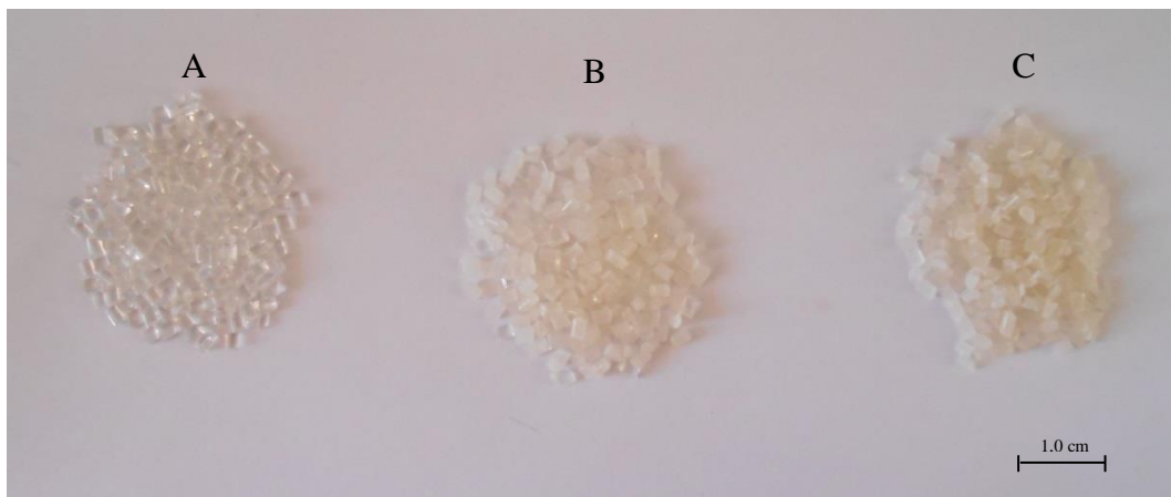
Figura 2.12: Materiais extrudados em extrusora dupla rosca: Poliacido Lático (A), compósito reforçado com 0,5% de CMF (B) e compósito reforçado com 1,5% de CMF (C).
