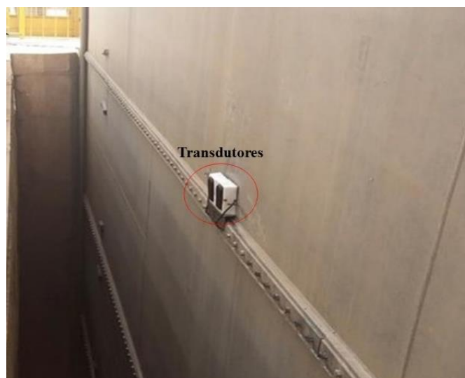
Figura 9. Transdutores instalados no painel de face da comporta vagão entre o segundo e terceiro elemento.
