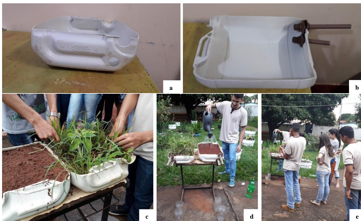
Figura 3. Montagem do experimento, partes usadas e estudantes realizando testes. a) Galão serrado, ao meio, com furos para instalação das franjas; b) Galão com franjas instaladas; c) Alunos fazendo plantio de ervas em um dos “recipientes”; d) Experimento em funcionamento, montado e sendo testado por alunos; e) Alunos participando do experimento em aula prática.
